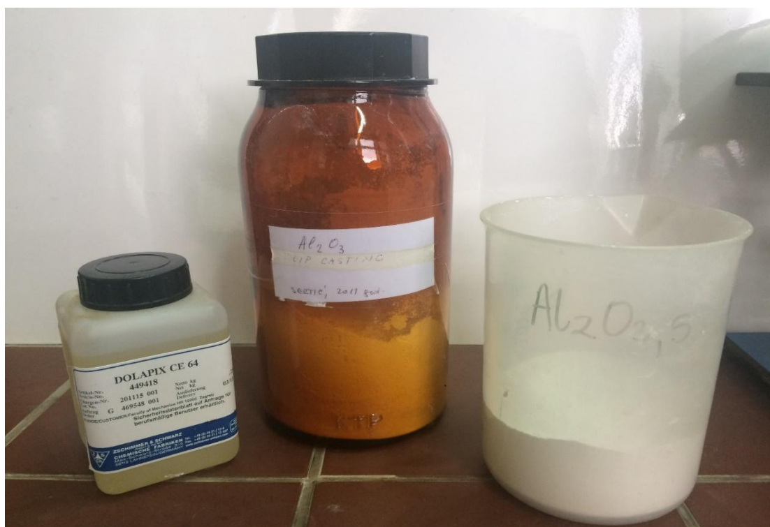
Slika 15. Dio upotrijebljenih sirovina (disperzant DOLAPIX CE 64, primarni ( \text{Al}_2\text{O}_{3,p} ) i sekundarni ( \text{Al}_2\text{O}_{3,s} ) keramički prah)
