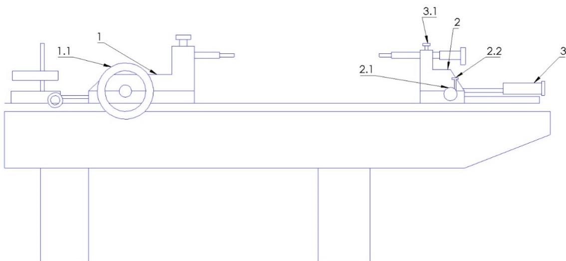
Slika 5- Shmetaska slika mjernog uređaja za mjerjenje duljina do 3 metra
