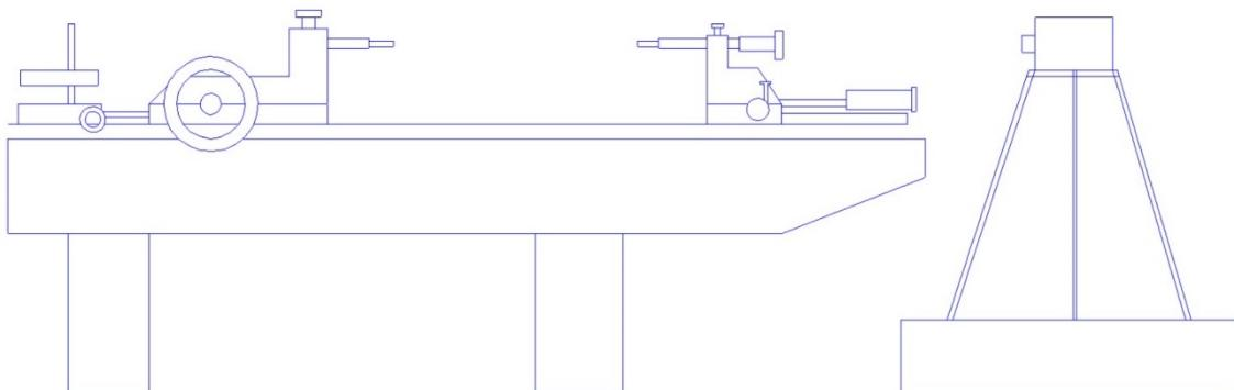
Slika 12- Druga konfiguracija opreme za umjeravanje duge mjerne skale
