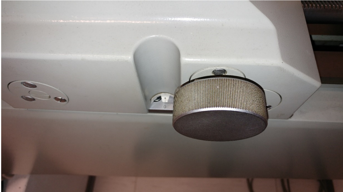
Slika 9- Sustav za pozicioniranje klizača početnog položaja i njegova mjerna skala
