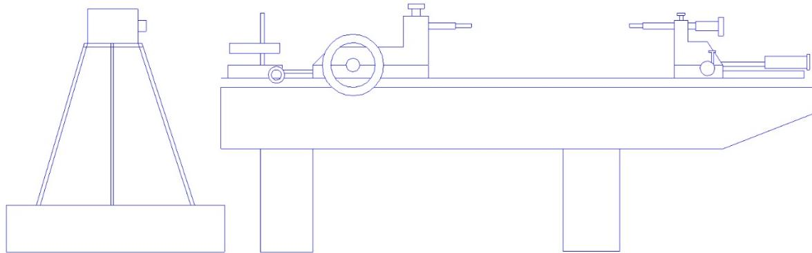
Slika 11- Prva konfiguracija opreme za umjeravanje duge mjerne skale
