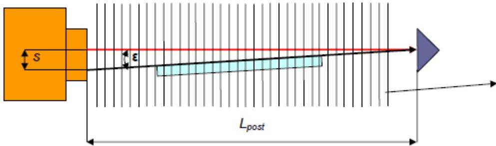
Slika 16- Shema kosinus poreške uslijed neporavnosti laserske zrake [6].
