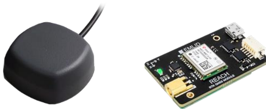
Slika 3.12 Reach RTK GNSS prijemnik [35]
