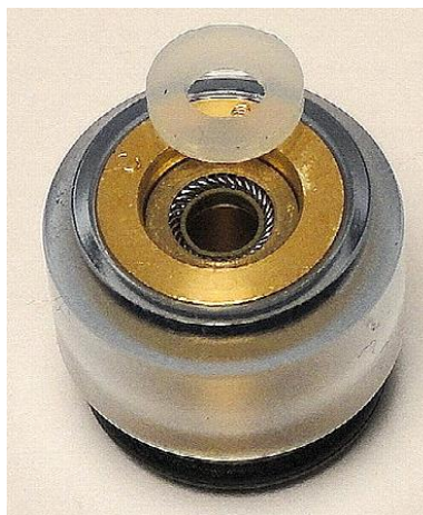
Slika 3.24 VideoRay PRO3 porivnik (lijevo) s „cartridge“ mehanizmom brtvljenja (desno)
