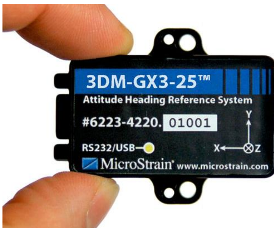
Slika 3.11 Microstrain 3DM-GX3 minijaturni MEMS IMU [31]
