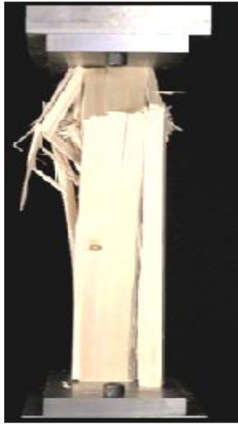
Slika 12. Prikaz tlačnja ispitne probe do loma [2]
