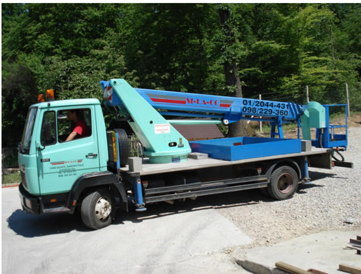
Slika 1.1 Kamion Mercedes-Benz 811 i dizalica Wumag WT 225
