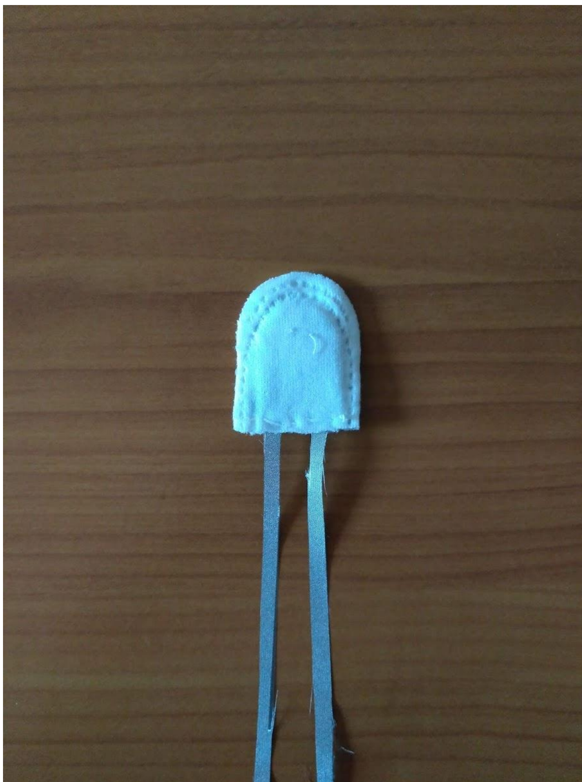
Slika 29. Taktilni senzor osjetljiv na dodir
