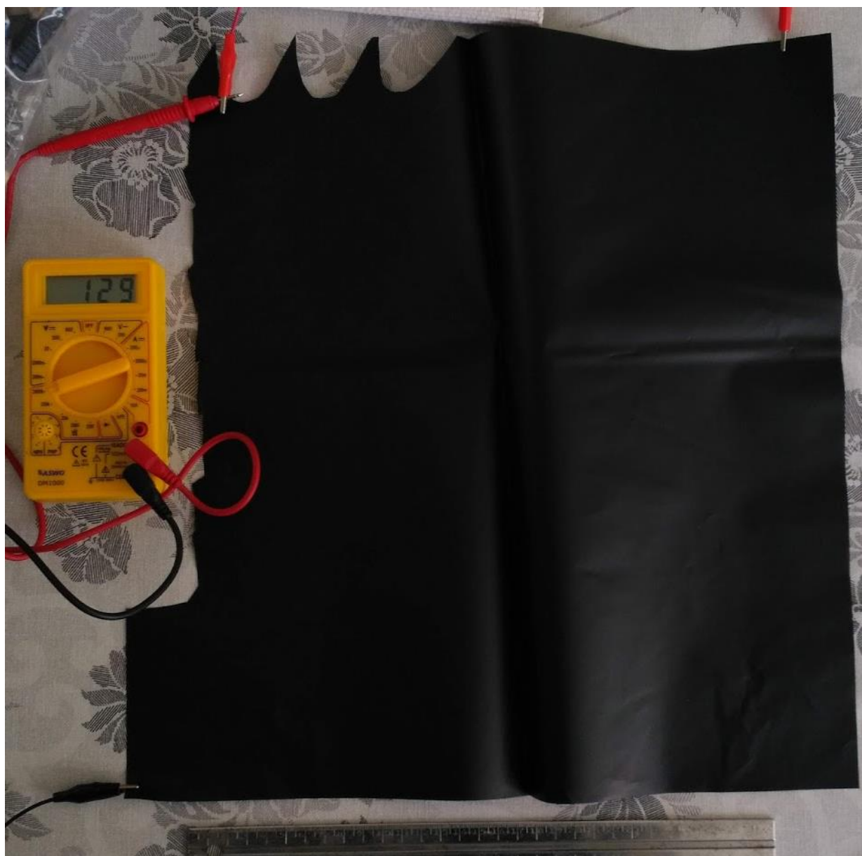
Slika 26. Električni otpor velostata
