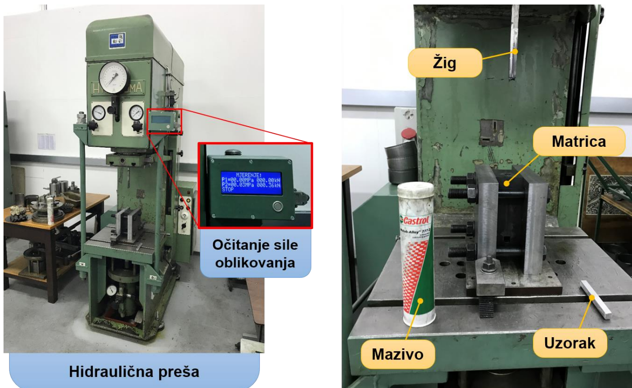
Slika 48 – Prikaz opreme i dijelova korištenih u eksperimentalnoj analizi
