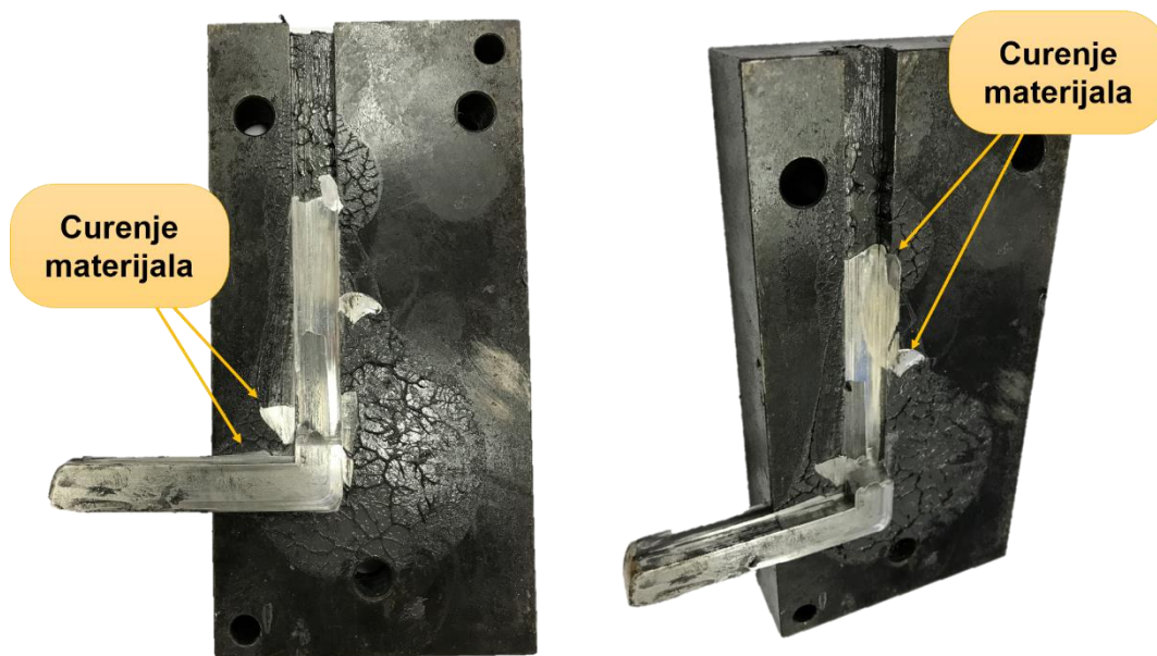
Slika 49 – Curenje materijala uzorka zbog deformacije matrice
