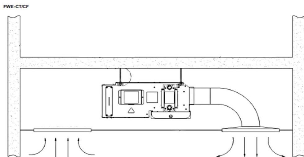
Slika 5. Primjer ugradnje kanalnog ventilokonvektora [5]
