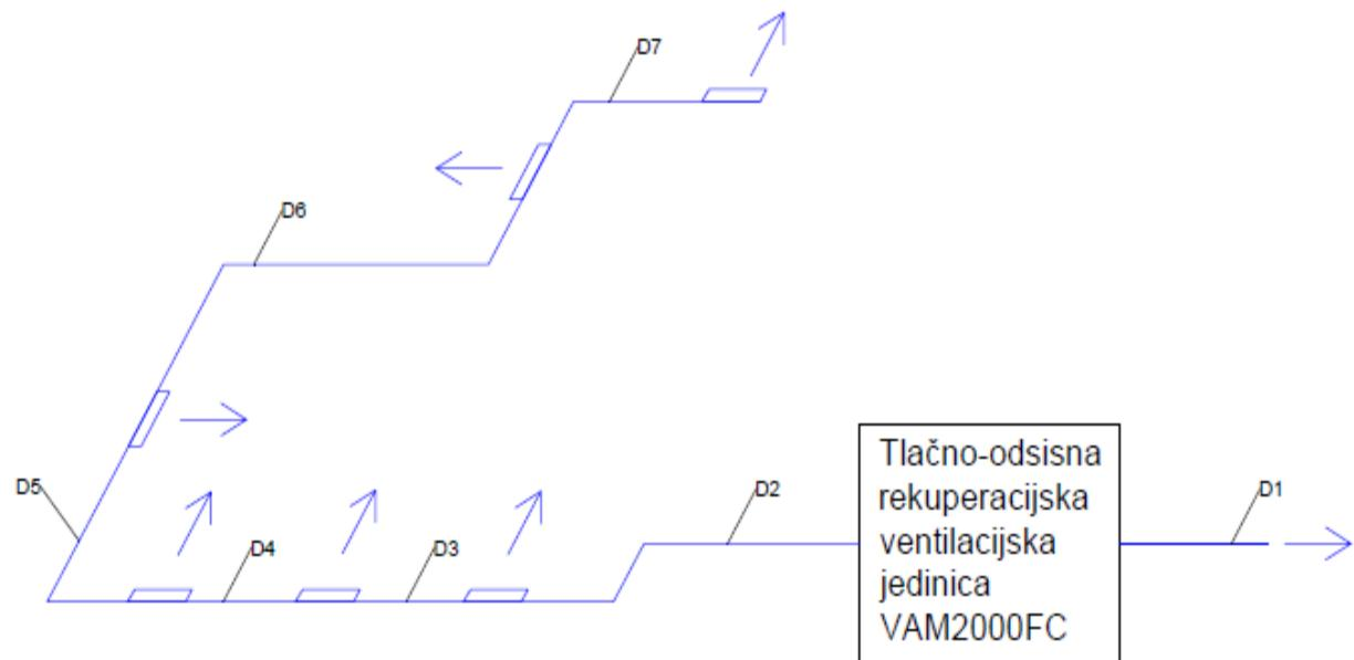
*Slika 26. Pojednostavljeni izometrijski prikaz kritične dionice ventilacije*
