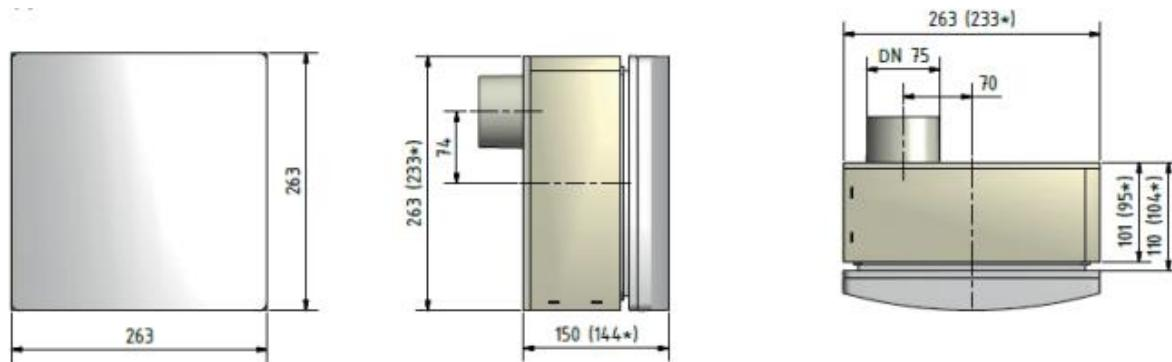
*Slika 27. VARIO II V-II U-H odsisna ventilacijska jedinica*
