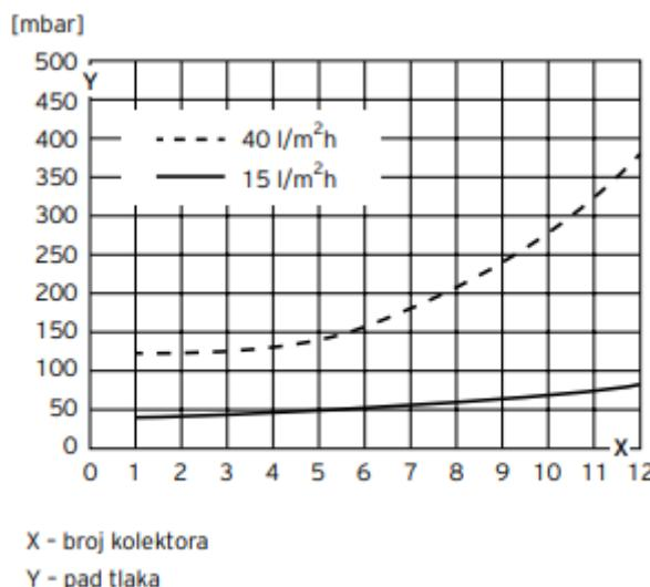
Slika 17. Pad tlaka u solarnim koletorima za predložene protoke solarne tekućine [5]
