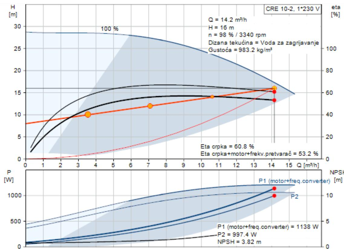
Slika 10. Karakteristika i radna točka pumpe CRE10-2 [7]
