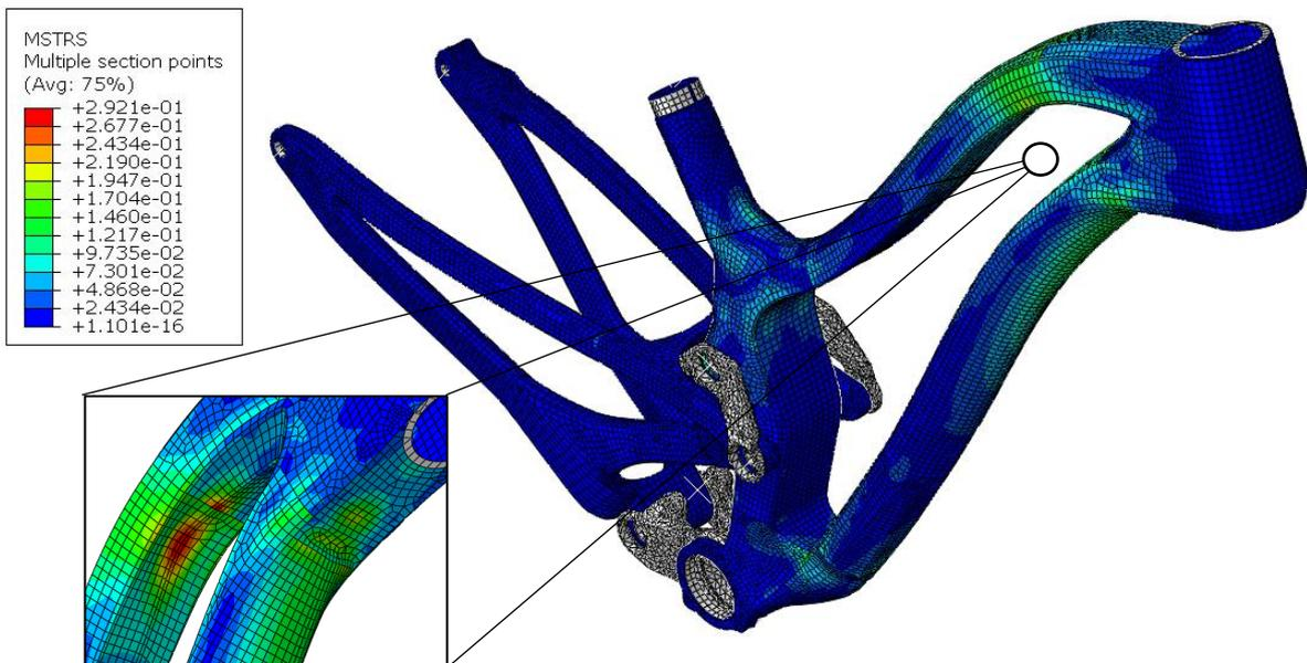
**Slika 34. Prikaz kriterija maksimalnog naprezanja za zadnji sloj [0°] kompozitne konstrukcije**
