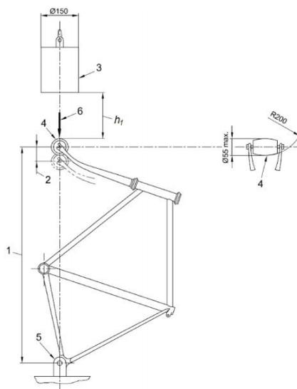
Slika 11. Shema testnog modela prema ISO 4210-6-2015
