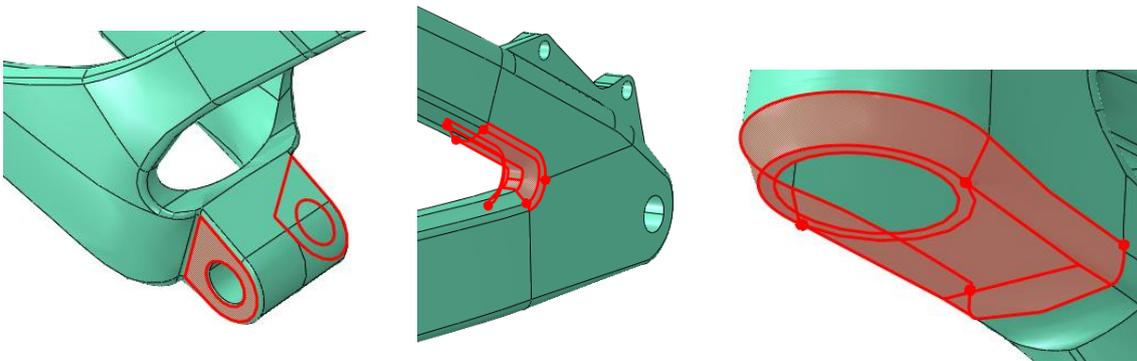
Slika 30. Prikaz ojačane površine spoja
