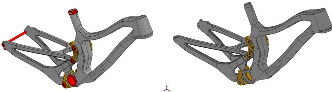
**Slika 15. 3D model *down-hill* bicikla tvrtke *Hardcore Industry* sa svim dijelovima rame (lijevo) i dijelovima koji se koriste u numeričkoj analizi (desno)**
