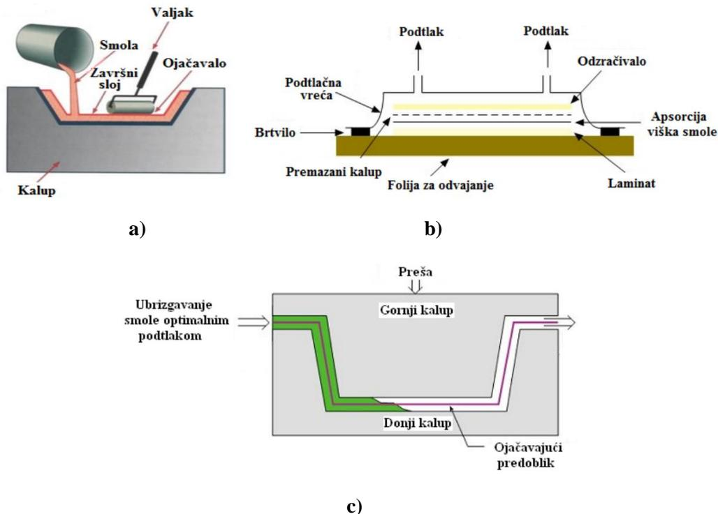
Slika 5. Postupci proizvodnje kompozitnih dijelova: a) ručno dodirno laminiranje b) podtlačno oblikovanje c) injekcijsko (RTM) [4]
