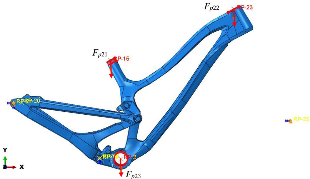
**Slika 27. Prikaz vertikalnih sila prema normi ISO 4210-6-2015**
