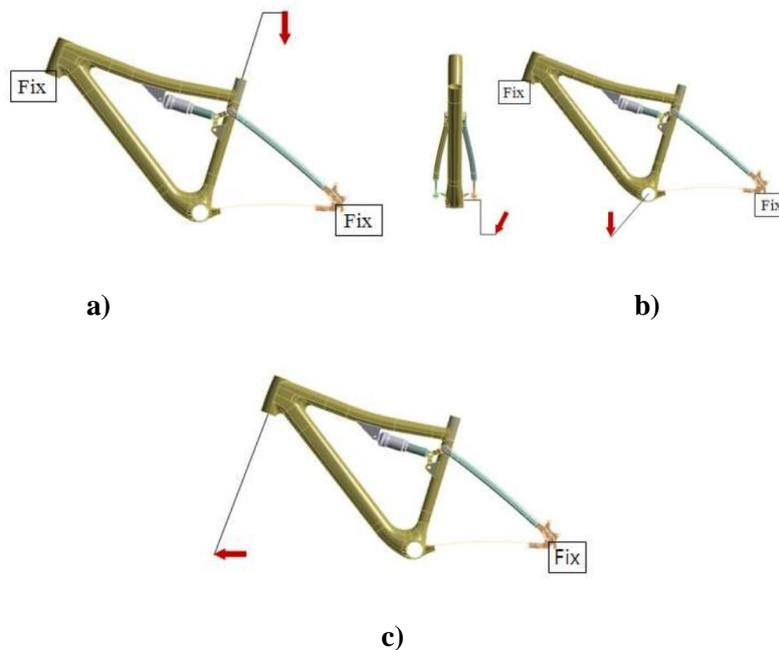
**Slika 9. Prikaz opterećenja i rubnih uvjeta rame bicikla: a) opterećenje uslijed težine vozača, b) opterećenje uslijed voznih sila, c) opterećenje uslijed vožnje [6]**
