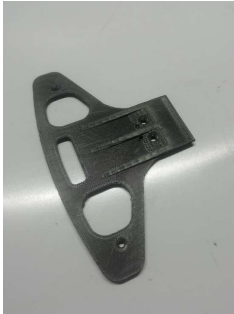
Slika 27. Izrađen 3D printani donji nosač spužvastog odbojnika
