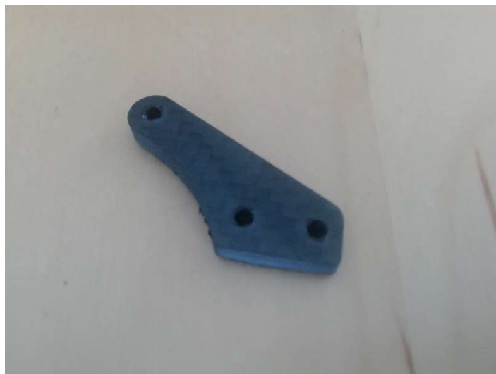
Slika 44. Nove GT pločice skretanja glavčine
