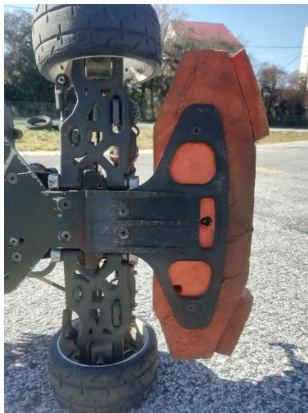
Slika 28. Prednji branik postavljen na GT modelu
