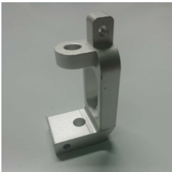
Slika 65. Izrađeni nosač glavčine sa smanjenim zatorum (0°)
