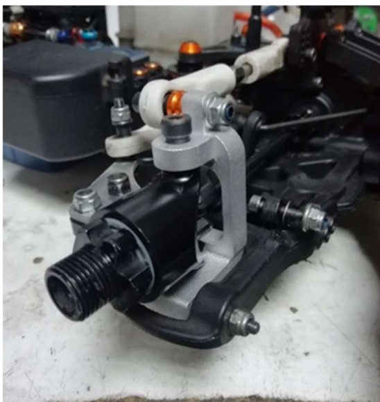
Slika 66. Instaliran novi 0° nosač glavčine na GT modelu
