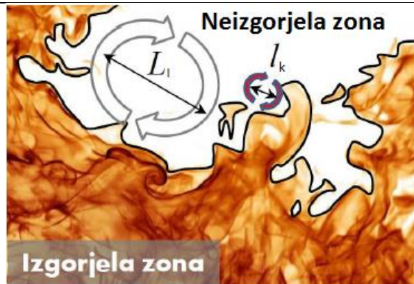
Slika 19. Podjela mješavine u cilindru na izgorjelu i neizgorjelu zonu [19]
