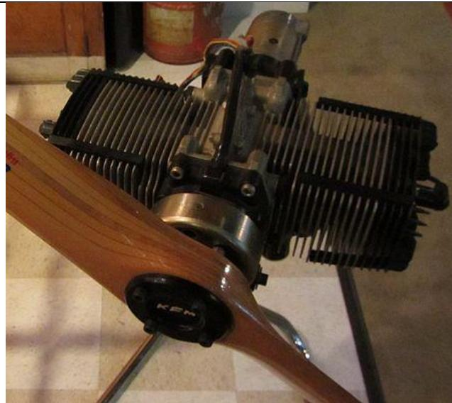
**Slika 8. KFM 107 zrakoplovni motor [11]**
