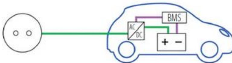
**Slika 17.** Shema punjenja električnog vozila na šuko utičnici [21]
