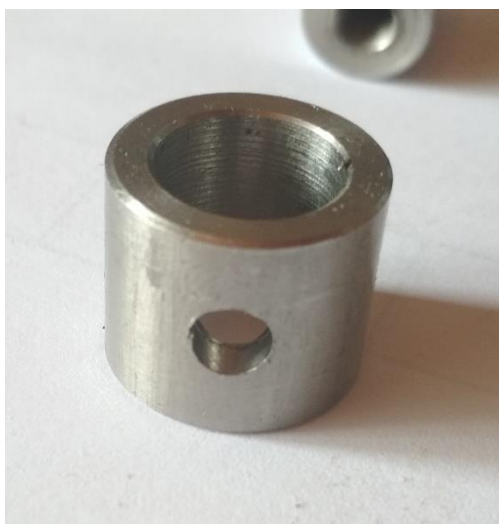
Slika 4. Greben za aktiviranje ventila
