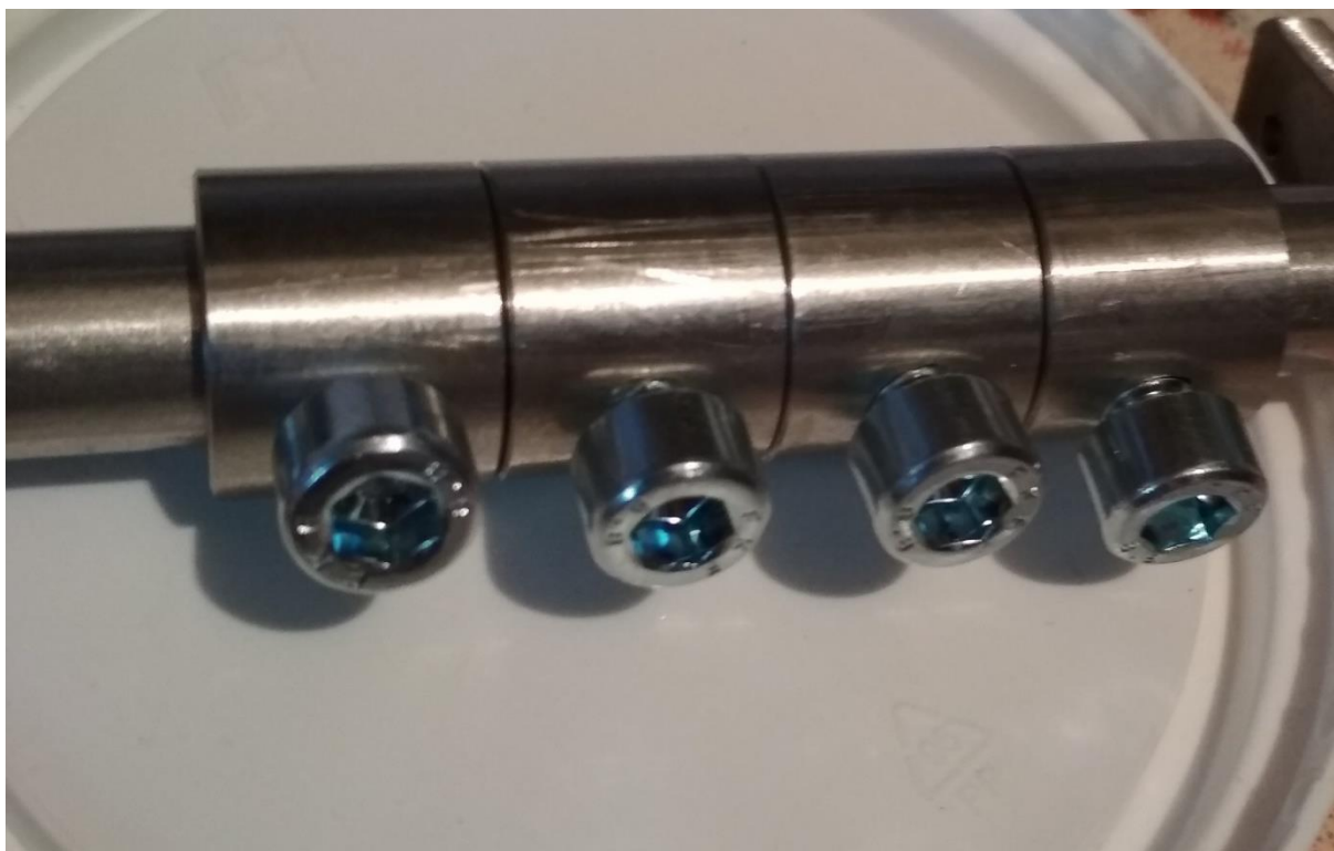
Slika 6. Pozicija grebena na vratilu
