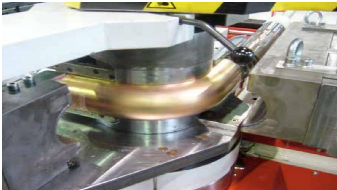
Slika 6. Postupak savijanja cijevi od Cu – Ni legure [10]
