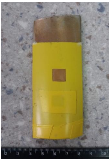
Slika 29. Uzorak pripremljen za elektrokemijsko ispitivanje
