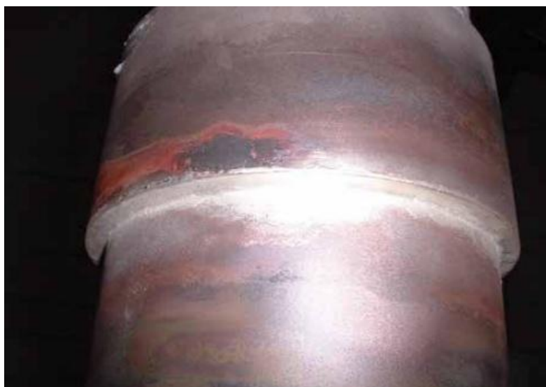
Slika 8. Spoj Cu – Ni cijevi izveden tvrdim lemljenjem [10]
