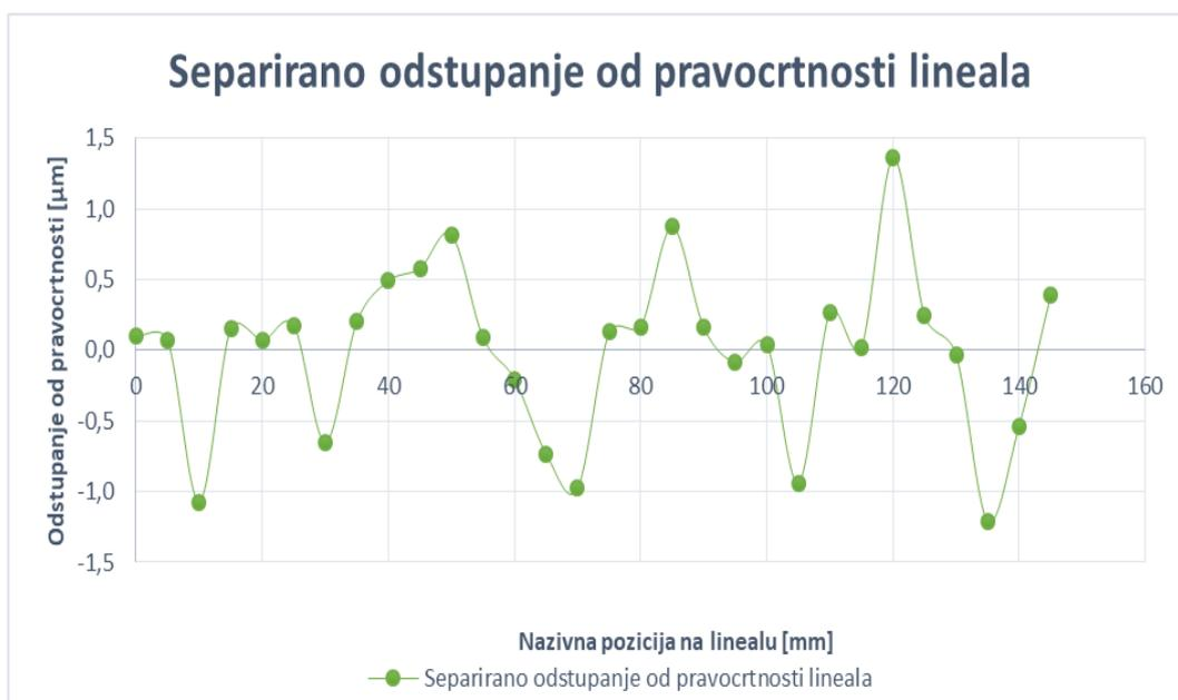
Slika 79. Separirano odstupanje od pravocrtnosti metalnog lineala
