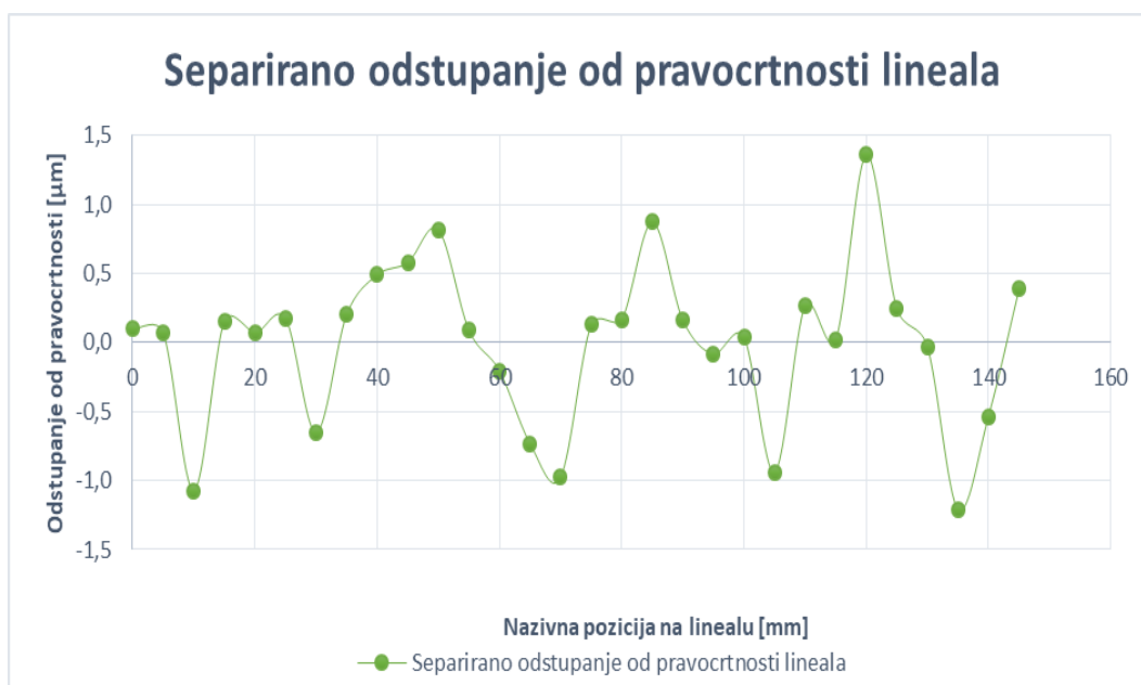
Slika 79. Separirano odstupanje od pravocrtnosti metalnog lineala
