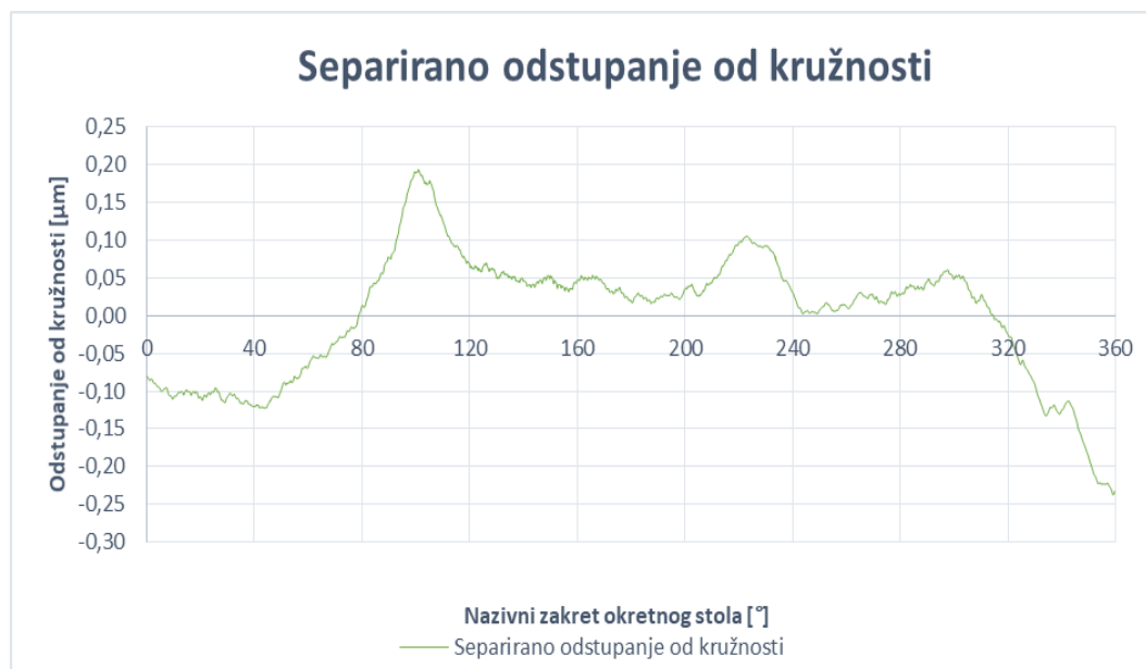
Slika 96. Separirano odstupanje od kružnosti
