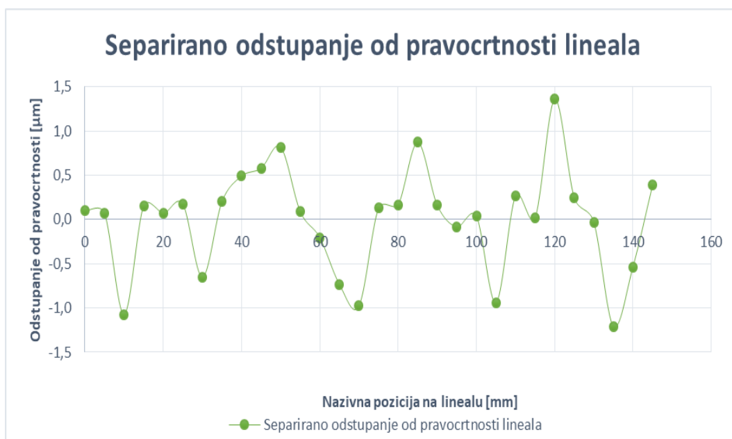
Slika 79. Separirano odstupanje od pravocrtnosti metalnog lineala
