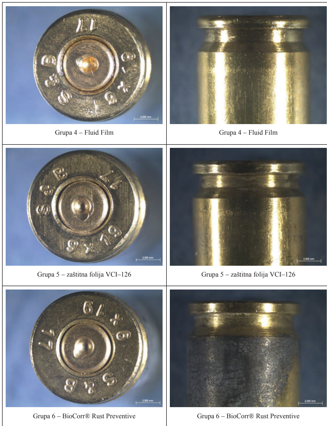
Tablica 14. Prikaz površine uzoraka iz vlažne komore nakon čišćenja korozivskih produkata (nastavak).
