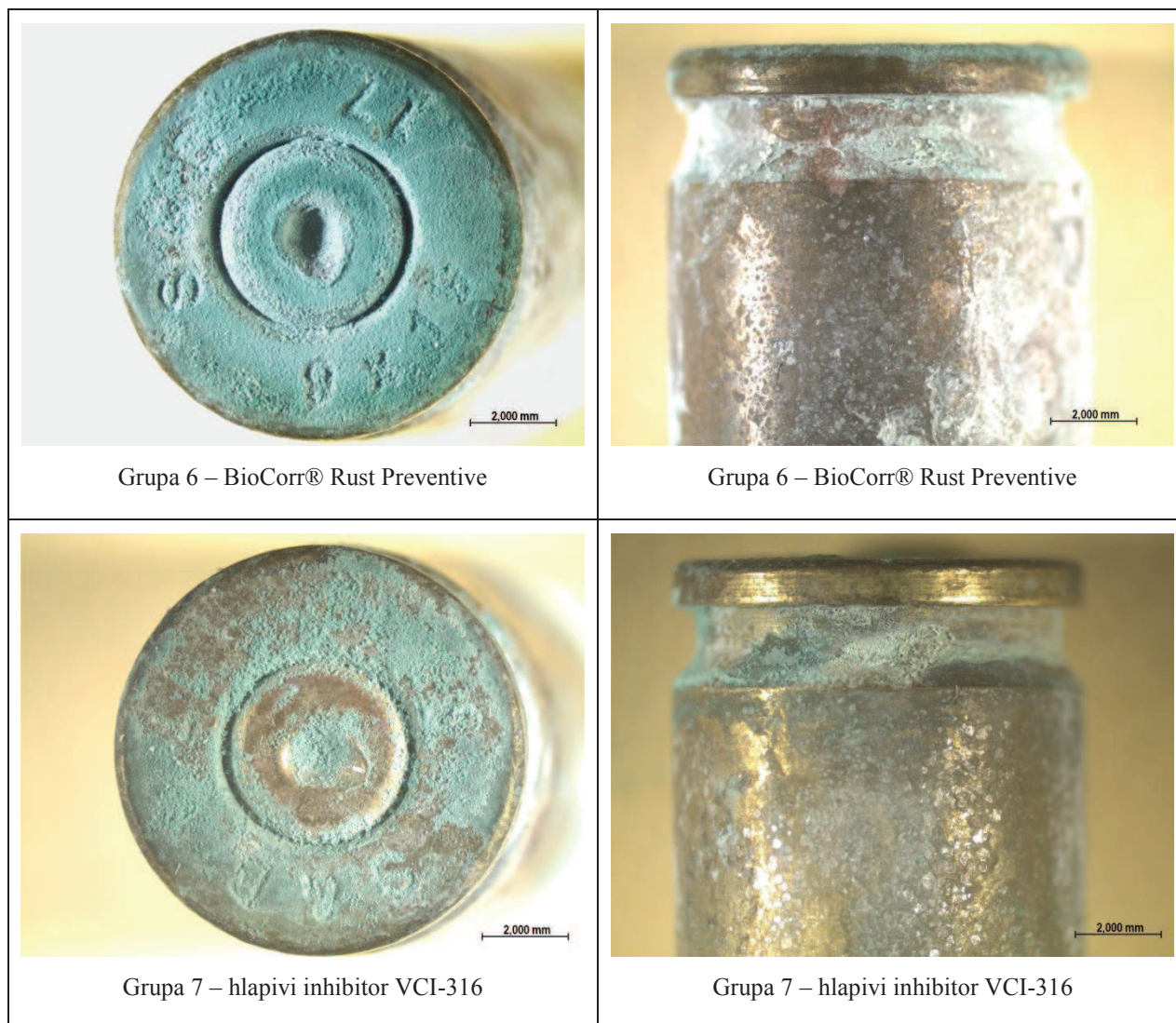
Tablica 21. Prikaz površine uzoraka nakon provedenih ispitivanja u slanoj komori (nastavak).
