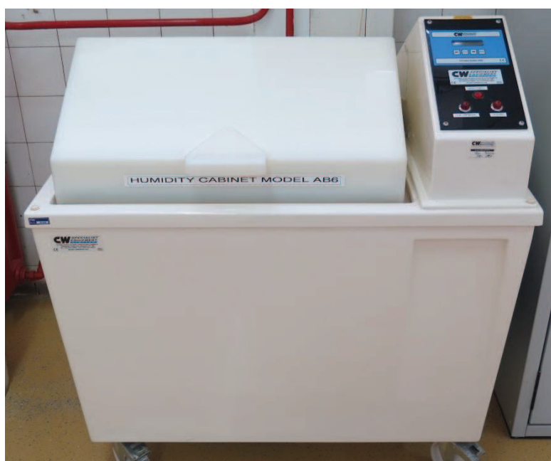
Slika 19. Vlažna komora C&W, Humidity Cabinet Model AB6 - Laboratorij za zaštitu materijala.
