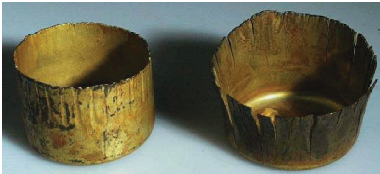
Slika 15. Napetosna korozija čahura strjeljiva nastala u agresivnom okruženju amonijaka [11].
