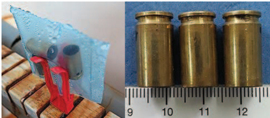
Slika 39. Uzorci u zaštitnoj foliji tijekom (lijevo) i nakon ispitivanja (desno) u slanoj komori.
