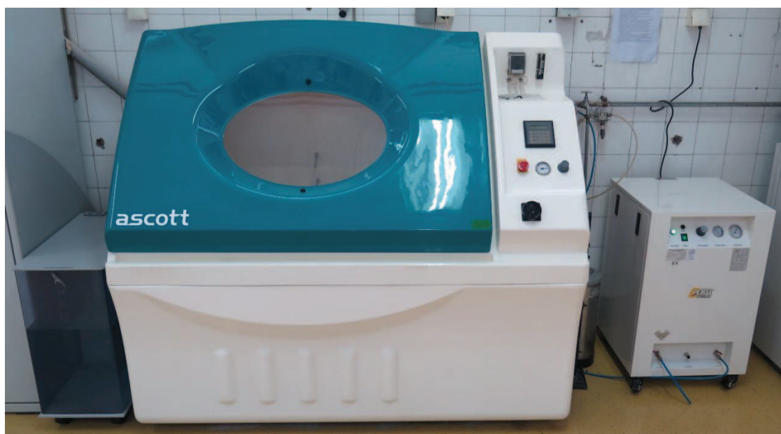
Slika 21. Slana komora Ascot S450 - Laboratorij za zaštitu materijala.
