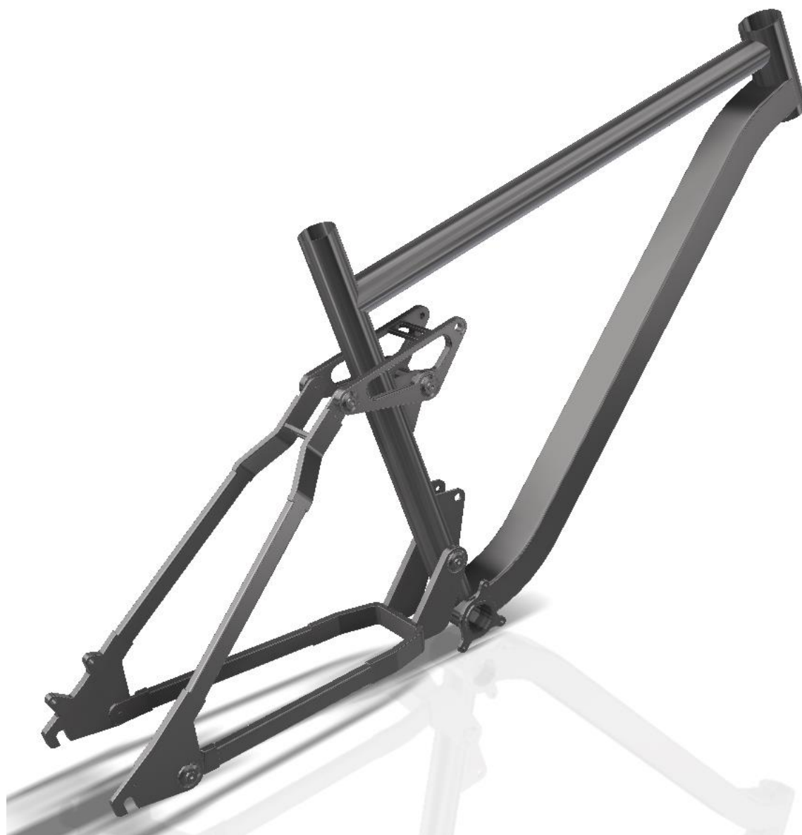
Slika 6.7. Model konstrukcije okvira
