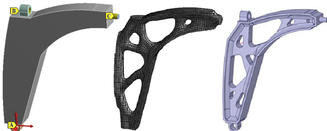
Slika 42. Topološka optimizacija nosača
