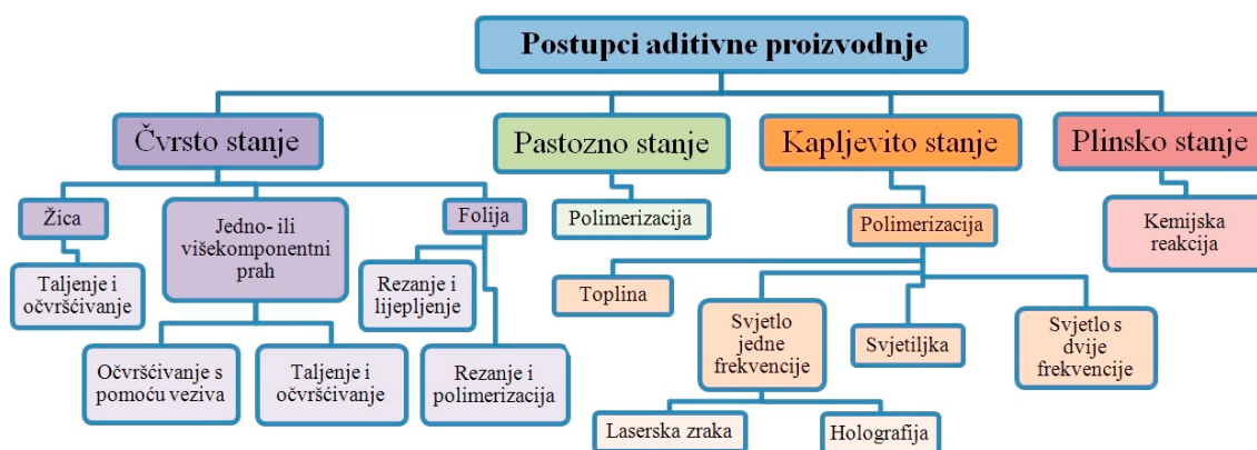
Slika 52. Postupci aditivne proizvodnje s obzirom na izvorno stanje materijala i fiziku procesa
