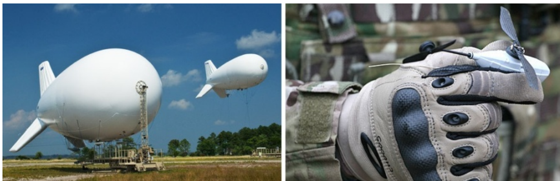
Slika 10. Podjela letjelica na aerostate i aerodine
