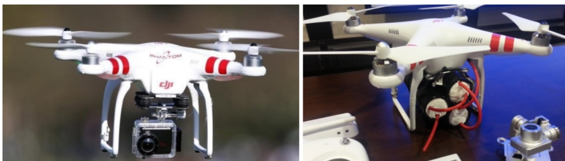
Slika 11. Različite uporabe iste platforme (DJI Phantom)
