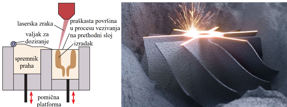
Slika 58. Shematski prikaz selektivnog laserskog srašćivanja popraćen primjerom
