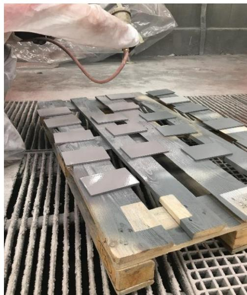
Slika 35 Nanošenje premaza na uzorke zračnim prskanjem
