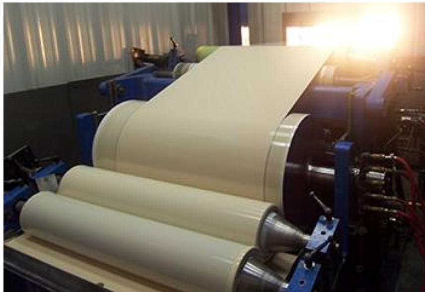
Slika 16 IC sušenje "coil coatinga" [32]
