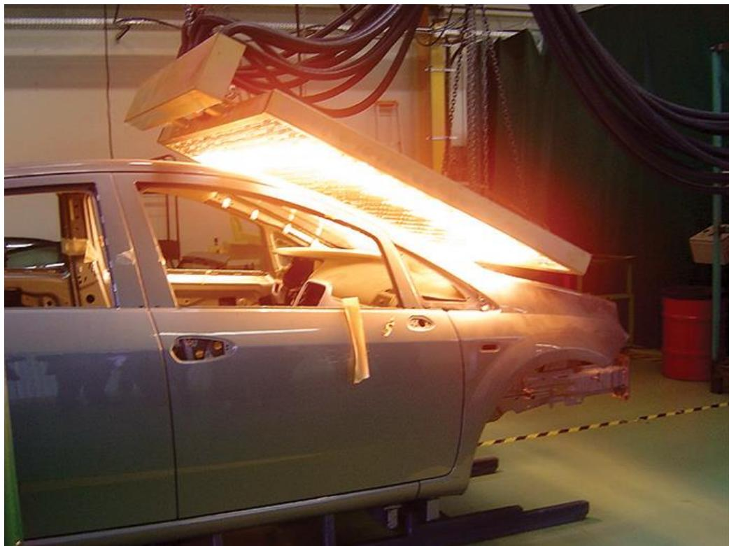
Slika 17 IC sušenje limova na automobilu [33]
