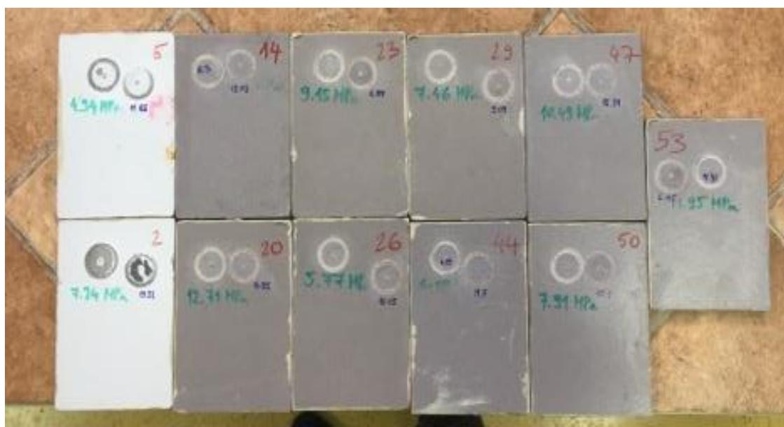
Slika 43 Uzorci nakon 720 h ispitivanja u vlažnoj komori te nakon provođenja ispitivanja prionjivosti premaza
