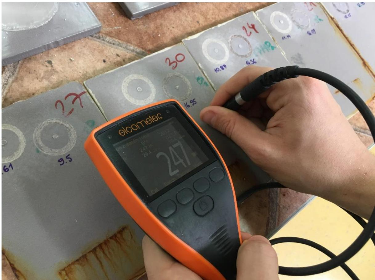
Slika 37 Mjerenje debljine suhog filma premaza uređajem Elcometer 456
