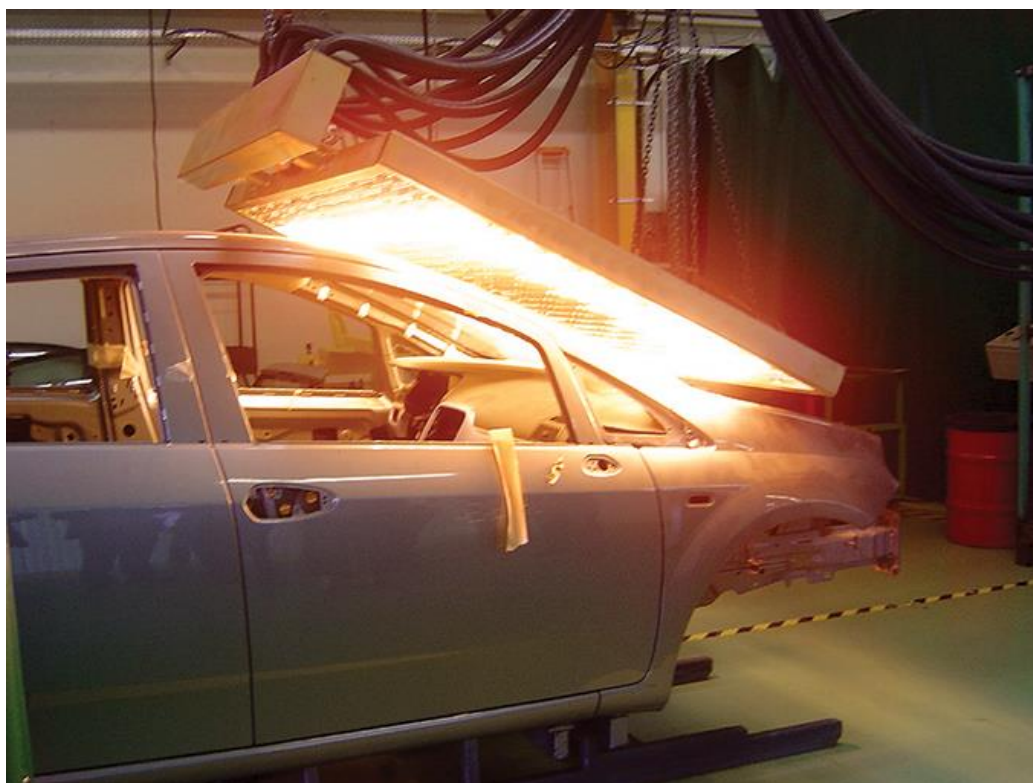
Slika 17 IC sušenje limova na automobilu [33]
