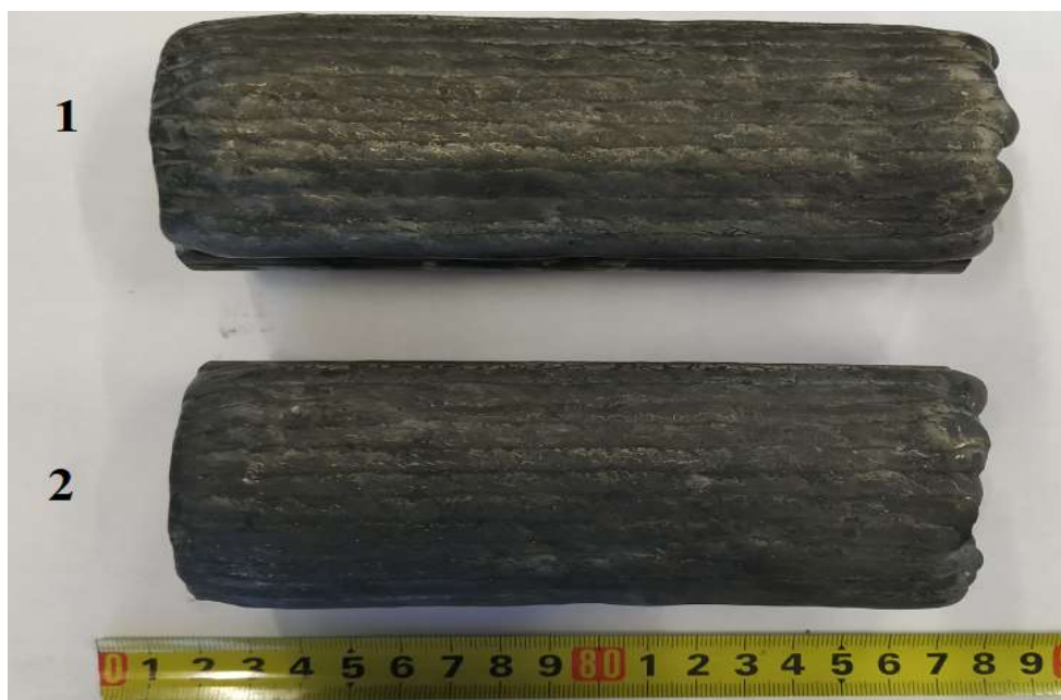
Slika 33. Izgled uzoraka nakon navarivanja – pogled odozgo
