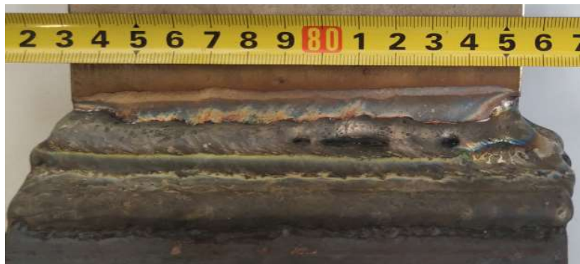
Slika 42. Uzorak 1 – prva strana; automatizirani MIG, neutralna tehnika
