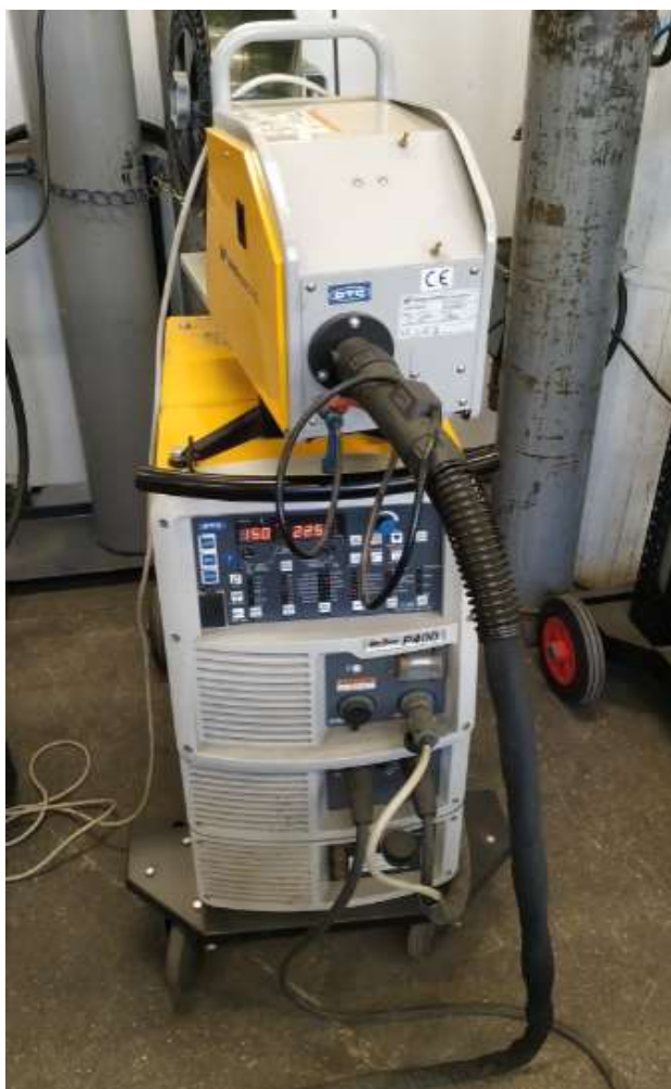
Slika 24. Izvor struje za zavarivanje Welbee P400
