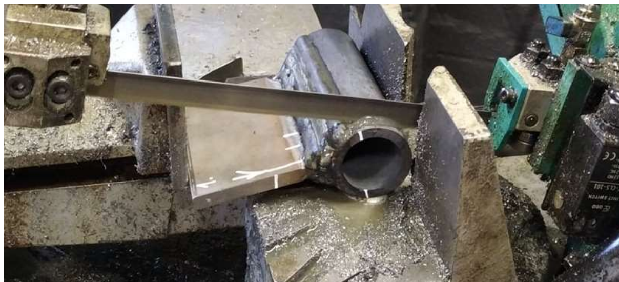
Slika 46. Izrezivanje makroizbrusaka tračnom pilom
