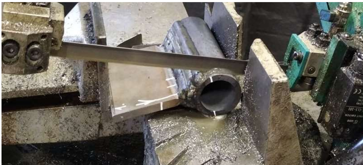
Slika 46. Izrezivanje makroizbrusaka tračnom pilom
