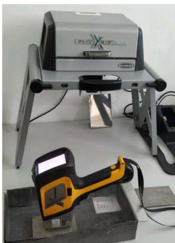
Slika 28. Utvrđivanje kemijskog sastava čelika X5CrNi18-10 korištenjem uređaja XRF-Olympus
