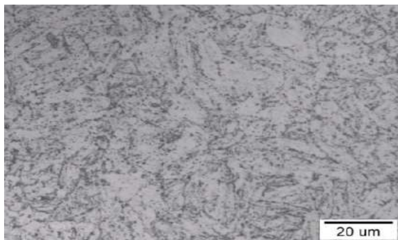
Slika 11. Mikrostruktura čelika P91 (svjetlosni mikroskop - 1000x) [13]
