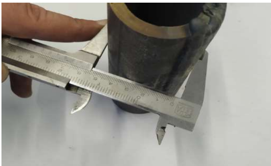
Slika 35. Indirektno mjerenje visine navarenog sloja
