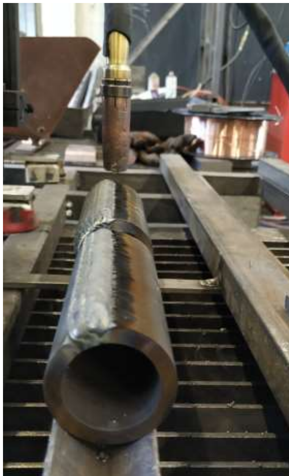
Slika 30. Položaj uzoraka tijekom navarivanja
