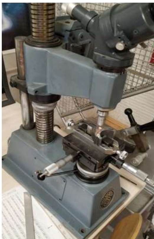
Slika 53. Uređaj za mjerenje tvrdoće
