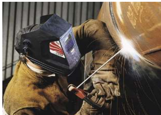
Slika 18. REL zavarivanje; lijevo-shematski prikaz, desno-realni prikaz [19,27]
