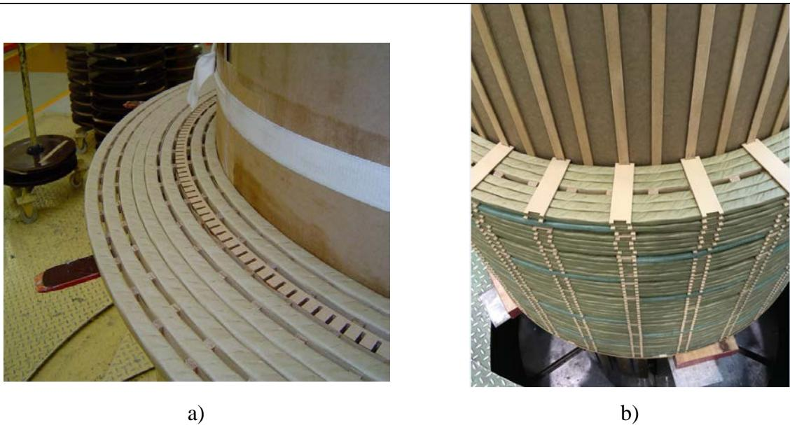
**Slika 5. Disk namot a) bez pločica i b) s pločicama**
