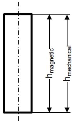
**Slika 6. Prikaz magnetske i mehaničke visine disk namota**
