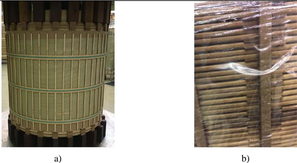
**Slika 3.** Spiralni namot a) bez radijalnih kanala i b) s radijalnim kanalima
