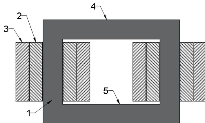
**Slika 1. Načelna izvedba jezgrastog transformatora**
