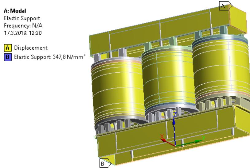
**Slika 32. Definiranje rubnih uvjeta u vibracijskoj analizi**
