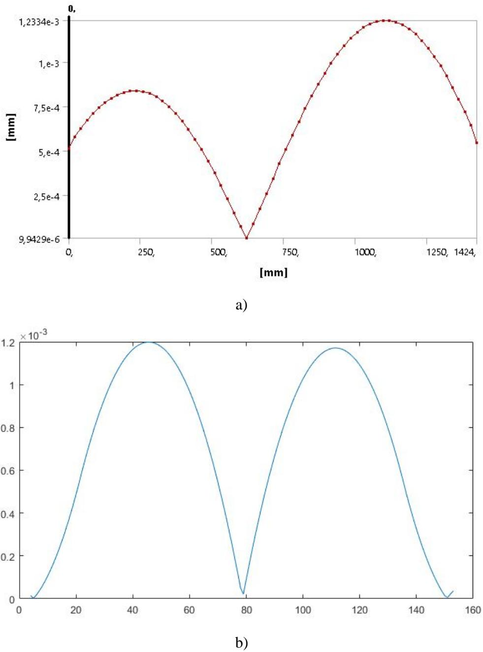
**Slika 53. Raspodjеле amplitude pomaka NN1 namota u a) ANSYSu i b) MATLABu**
