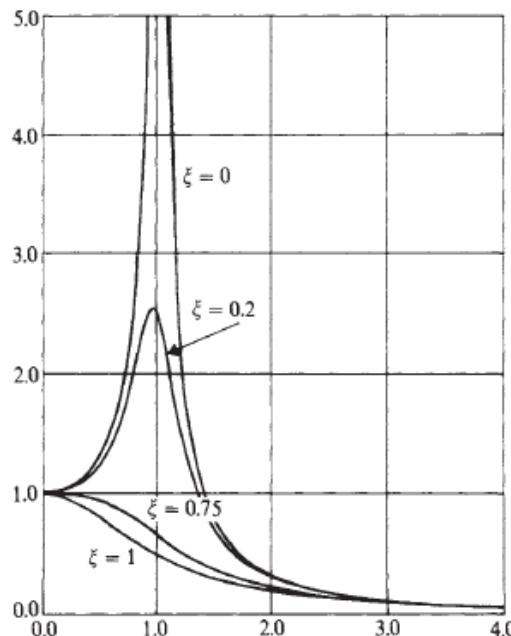
**Slika 16. Bodeov dijagram za bezdimenzijsku amplitudu odziva**
