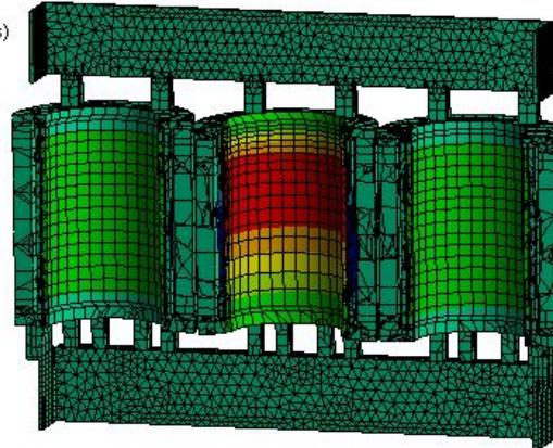
Slika 59. Četvrta forma vibriranja transformatora
