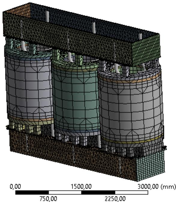
**Slika 31. Mreža konačnih elemenata u vibracijskoj analizi**
