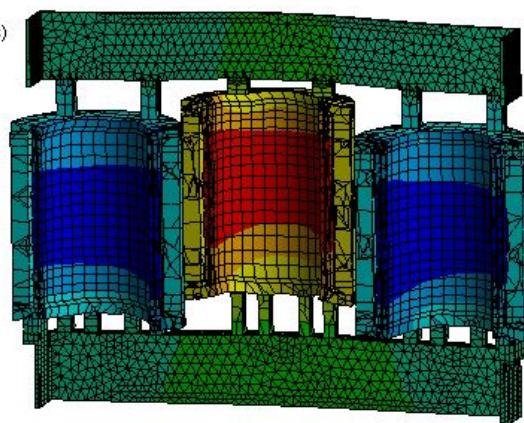
Slika 58. Treća forma vibriranja transformatora
