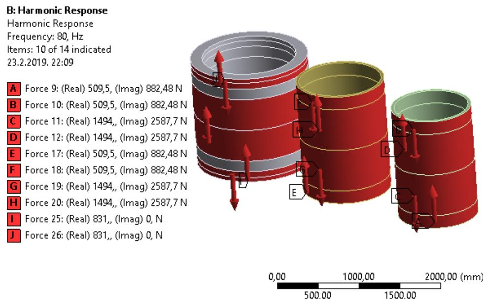
**Slika 35. Definiranje uzbude u vibracijskoj analizi**
