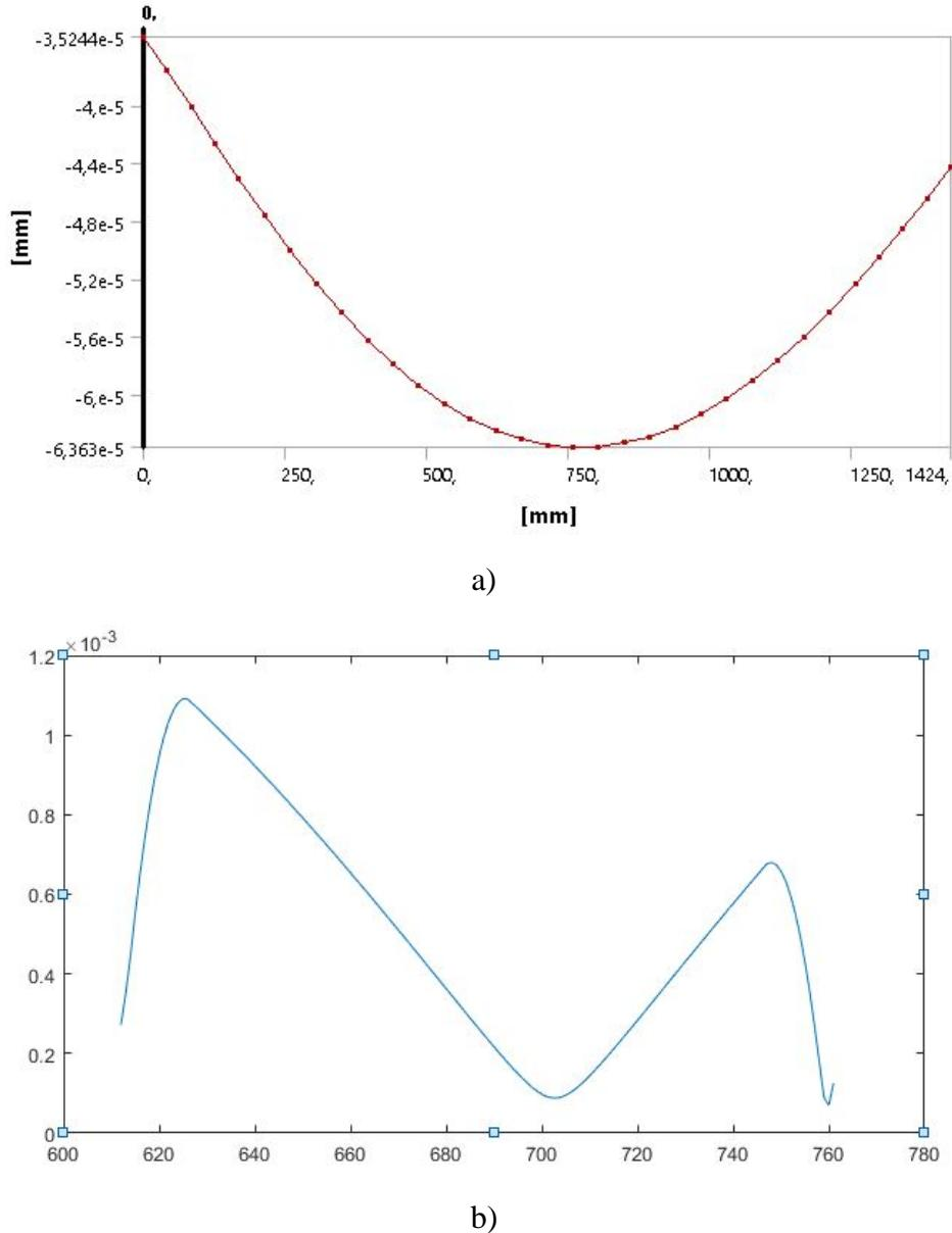
**Slika 62. Raspodjele amplitude pomaka NN2 namota kod srednjeg stupa transformatora u a) ANSYSu i b) MATLABu**
