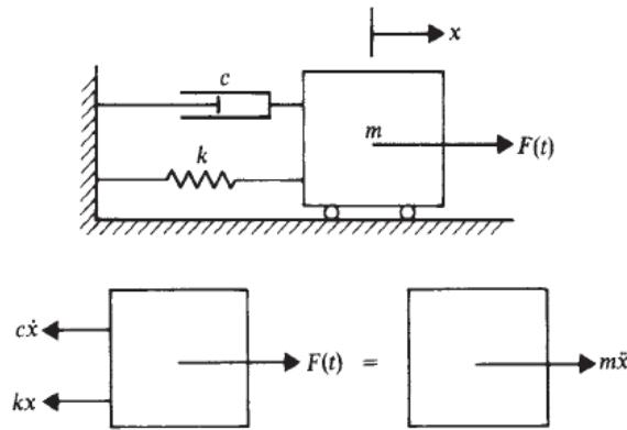
Slika 15. Prisilne vibracije sustava s jednim stupnjem slobode
