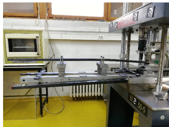
Slika 37. Testiranje lisnate opruge opterećivanjem opruge na jednom kraju
