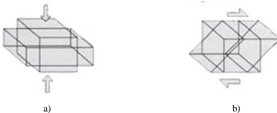
Slika 2.4. Primjer: a) čistog i b) jednostavnog smika [6]
