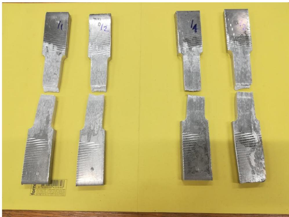
**Slika 28. Prikaz epruveta nakon ispitivanja**
