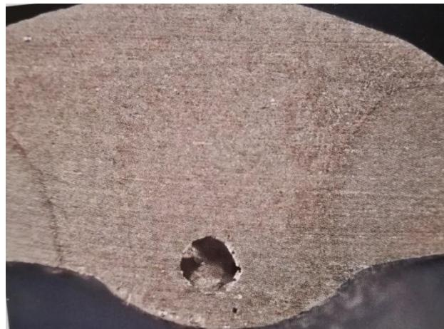
**Slika 5. Poroznost uslijed MIG zavarivanja aluminija [4]**
