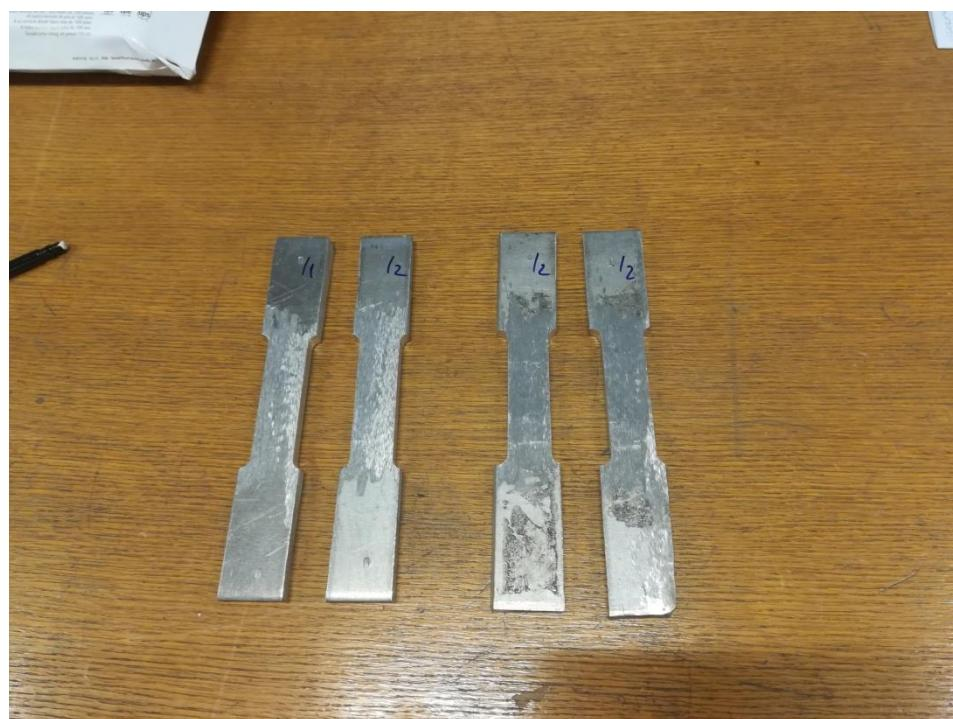
**Slika 27.** Prikaz epruveta prije ispitivanja
