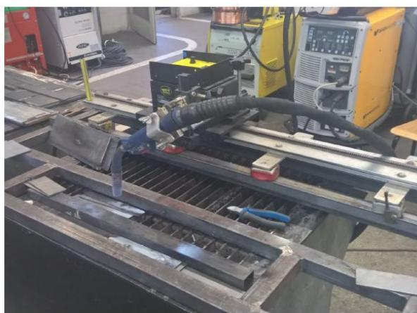
**Slika 18. Automatizirano vođenje pištolja**
