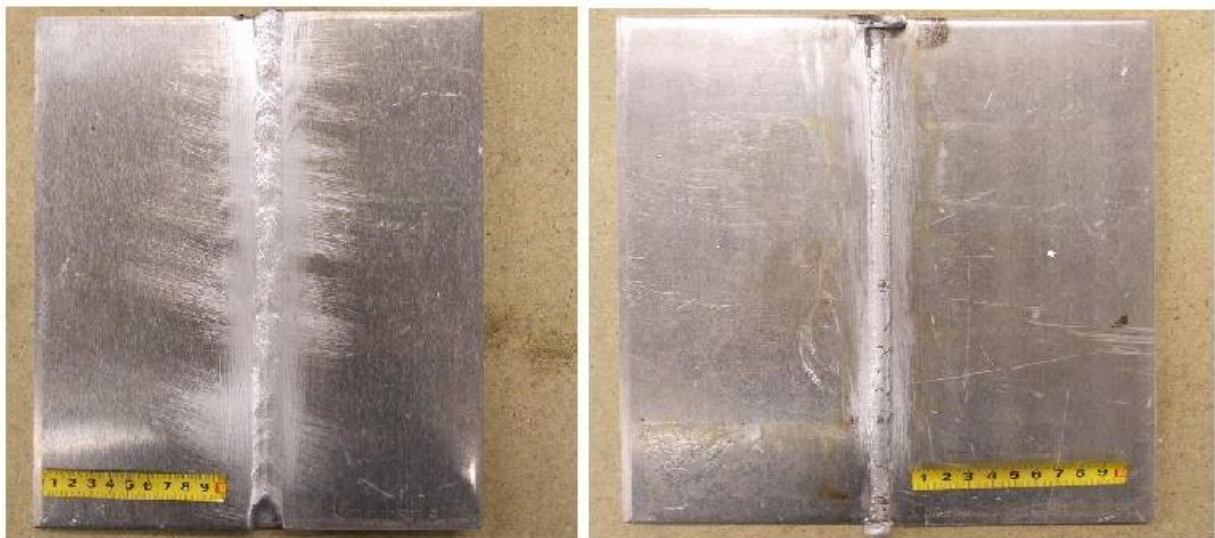
Lice zavara uzorka A
