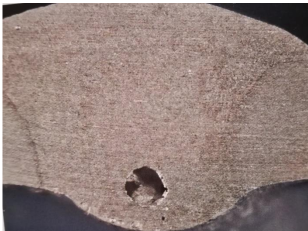
Slika 5. Poroznost uslijed MIG zavarivanja aluminija [4]
