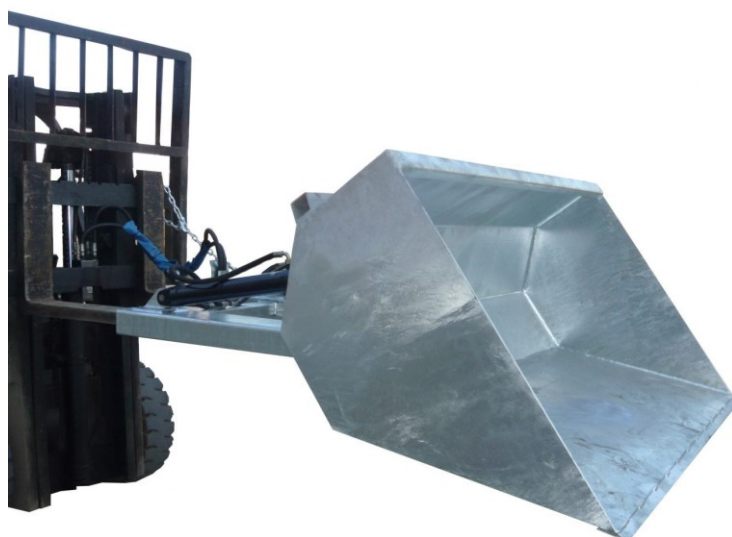
Slika 1.3 – Hidraulička utovarna lopata montirana na viličar
