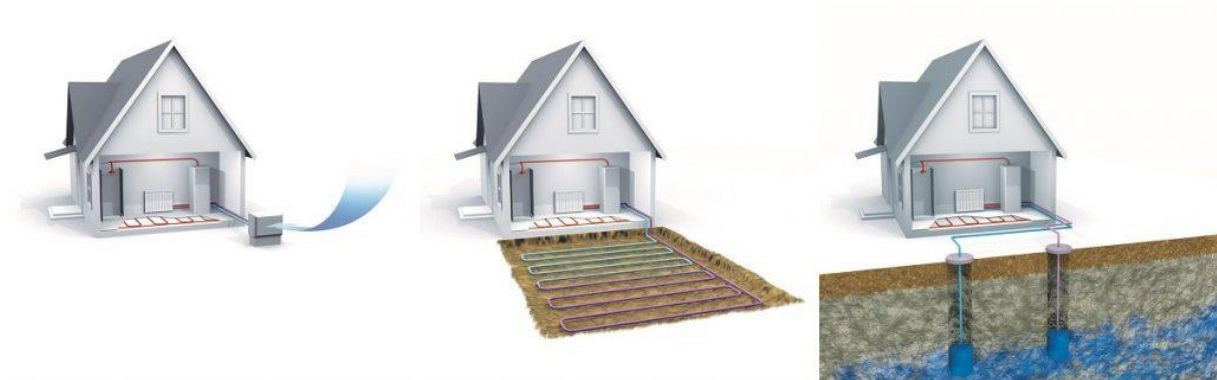
Slika 1.6 Izvori energije za dizalice topline
