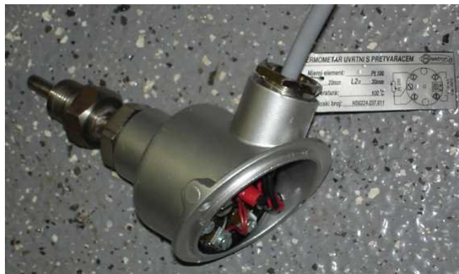
Slika 8: Temperaturna sonda Pt-100
