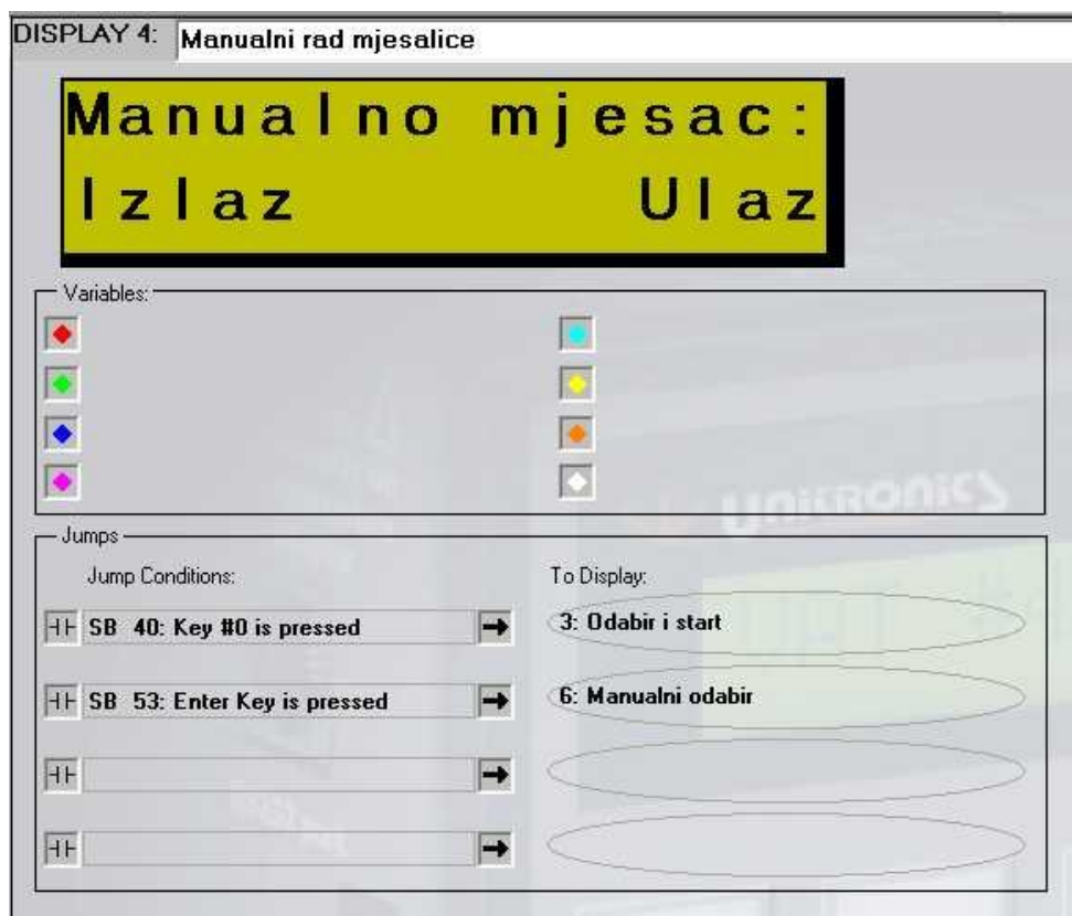
Slika 15.: „Display 4“ – Manualni rad mješalice
