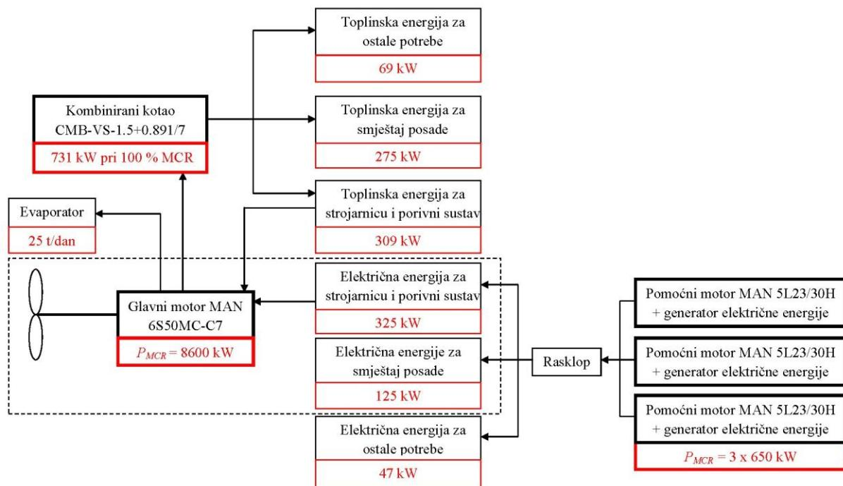
**Slika 7. Principijelna shema energetskog sustava broda „Stoja“**
