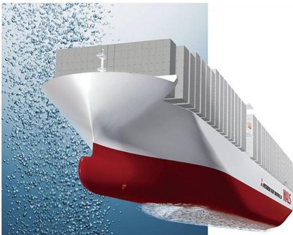
Slika 13. Skica sustava zračnog podmazivanja
