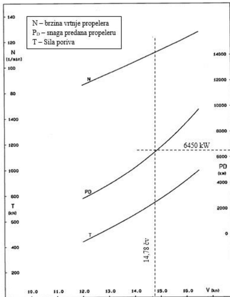
Slika 9. Prognozni dijagram pri teškom balastu (modelska ispitivanja)
