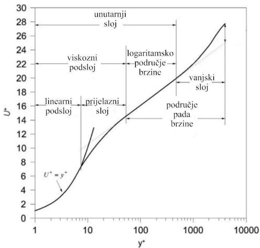
Slika 3 Profil brzine strujanja u turbulentnom graničnom sloju [15]
