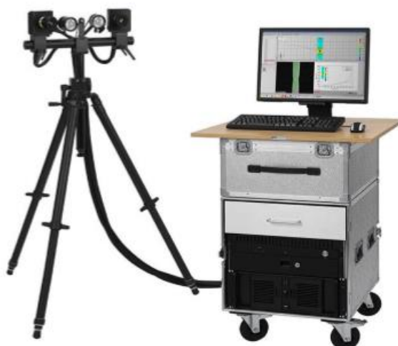
Slika 19. Optički mjerni sustav Aramis [22].
