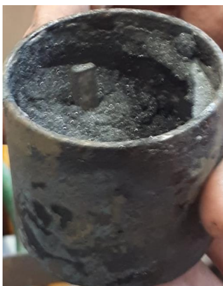
Slika 14. Primjer položaja uzorka u posudi od nehrđajućeg čelika
