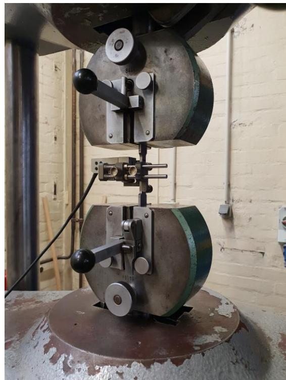
**Slika 15. Prihvat ispitnog uzorka pri statičkom vlačnom ispitivanju**
