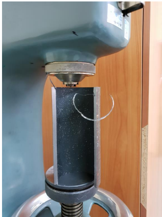
Slika 11. Mjerenje tvrdoće na novoj cijevi
