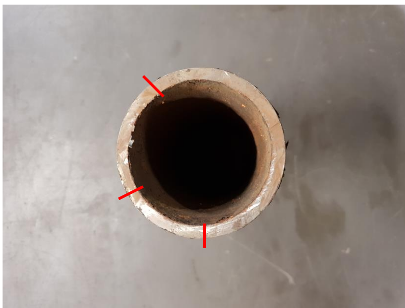
Slika 9. Prikaz stijenke i oblika nove cijevi
