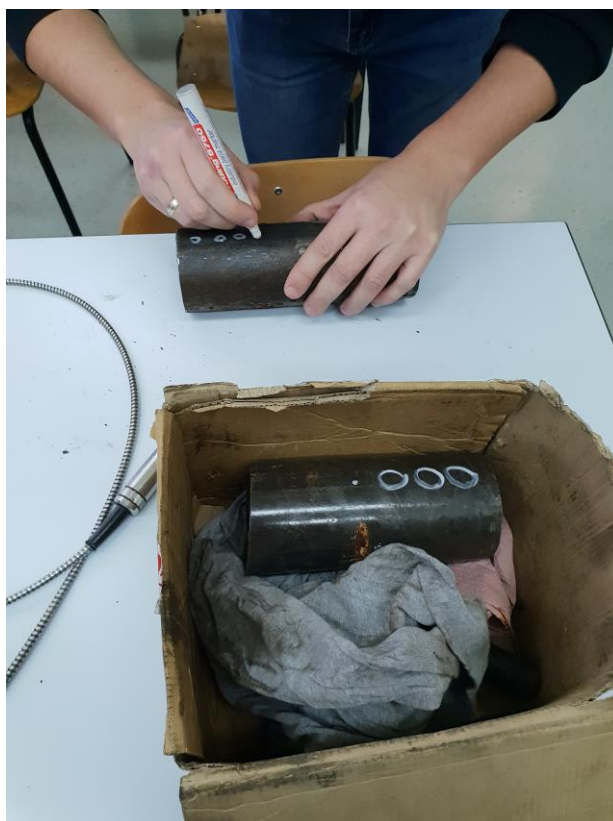
Slika 18. Označavanje mjesta za ispitivanje na cijevima
