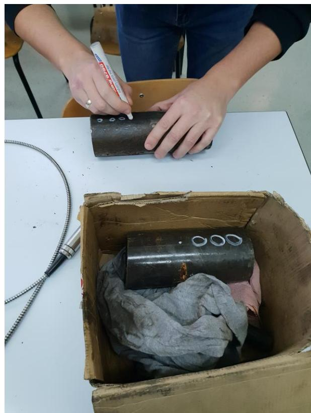
Slika 18. Označavanje mjesta za ispitivanje na cijevima
