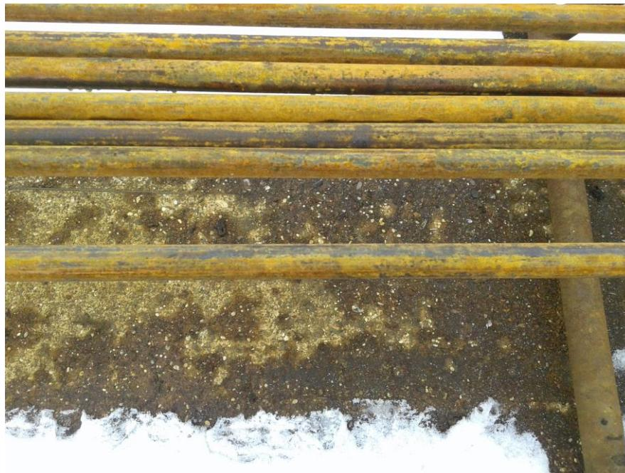
**Slika 4. Primjer oštećenja na crpnoj cijevi uzrokovanog korozijom, vanjsko oštećenje (naftno polje Žutica)**
