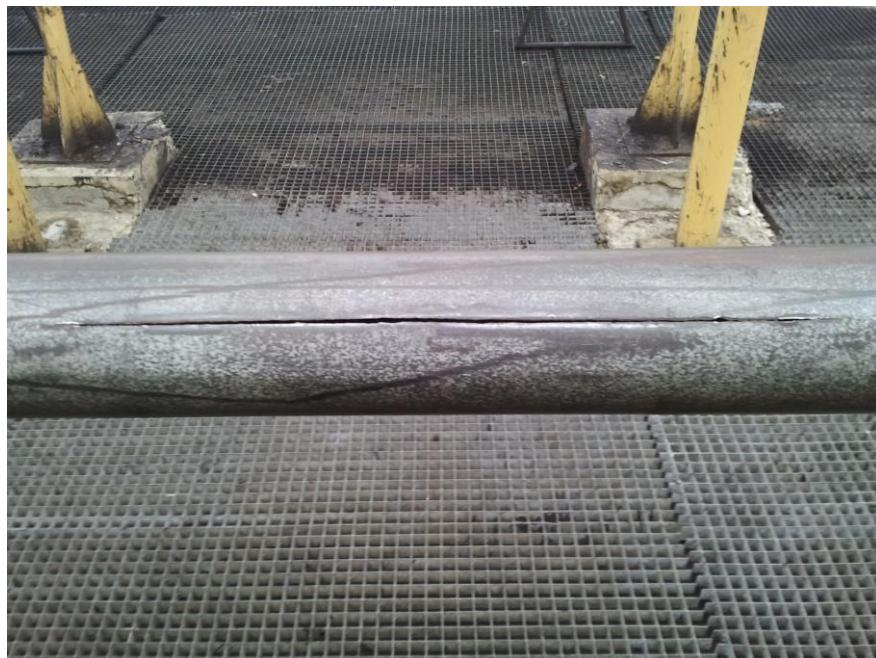
Slika 5. Primjer oštećenja na crpnoj cijevi uzrokovanog trenjem šipke, vanjsko puknuće (naftno polje Žutica)
