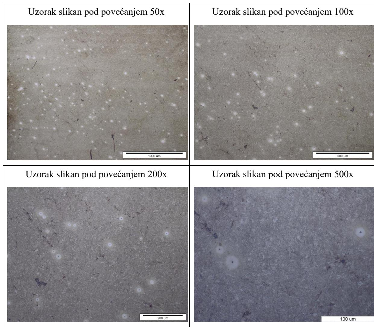
Mikrostruktura na slikama je homogena i nisu uočeni nikakve nečistoće ili nepravilnosti u strukturi.
