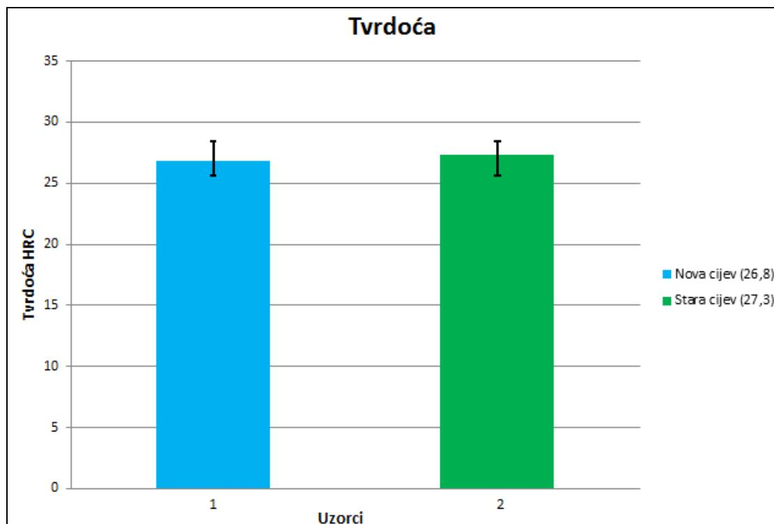
Slika 22. Usporedba dobivenih vrijednosti mjerjenjem tvrdoće
