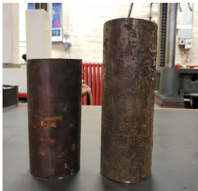
**Slika 8. Nova i stara crpna cijev**
