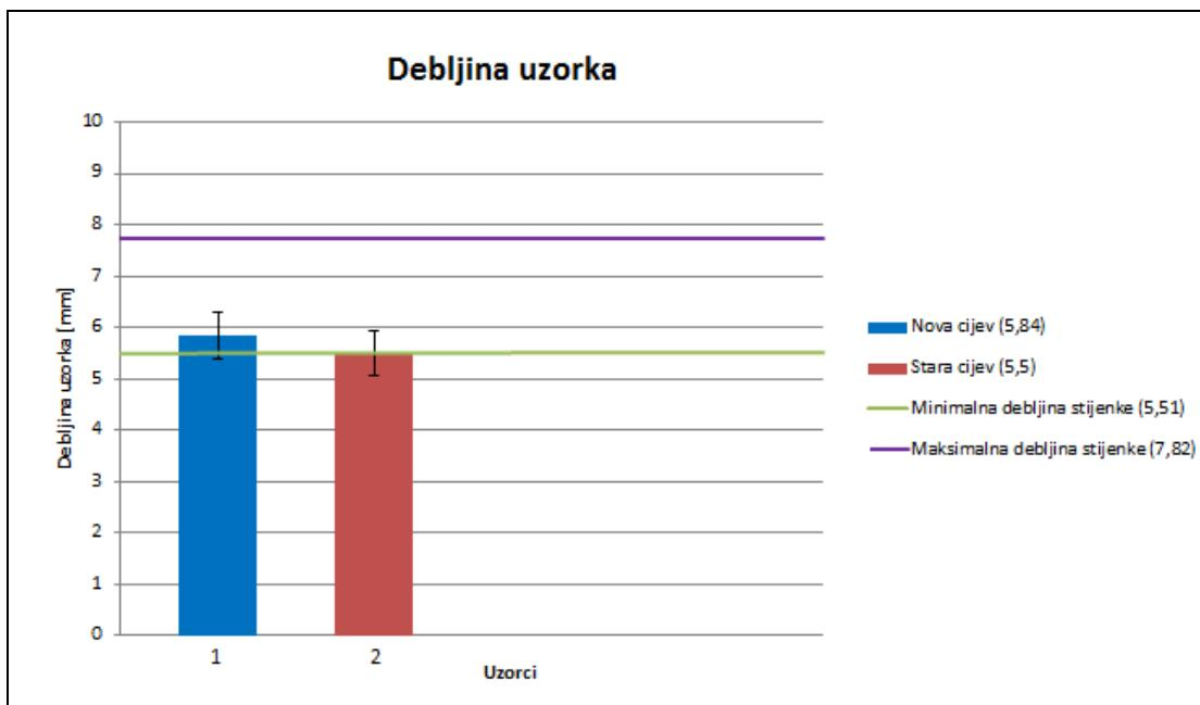
Slika 23. Usporedba vrijednosti dobivenih ultrazvučnim mjeranjem debljine stijenke
