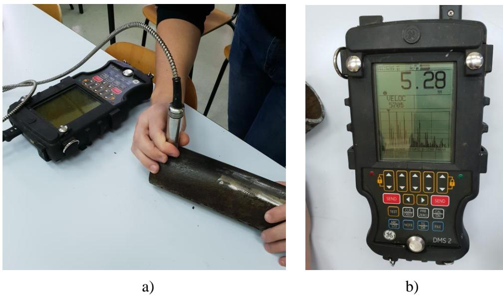
**Slika 19. Postupak mjerjenja debljine stijenke ultrazvukom**
