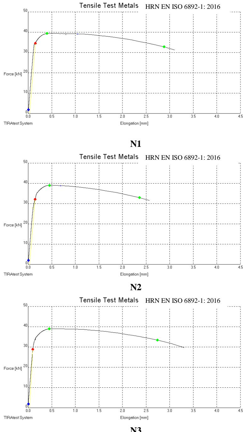
**Slika 16.  $\sigma$  -  $\epsilon$  dijagrami za epruvete N1, N2, N3**
