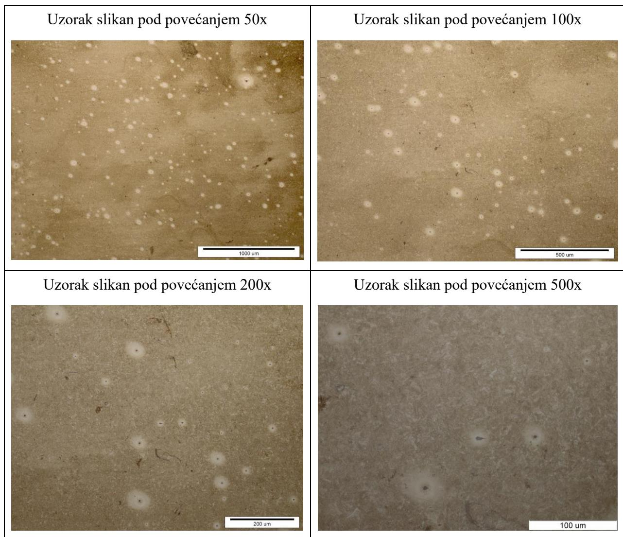
Mikrostruktura na uzorku stare cijevi je također homogena i nepromjenjena, bez nepravilnosti te vizualnom usporedbom identična mikrostrukturi uzorka uzetog iz nove cijevi.
