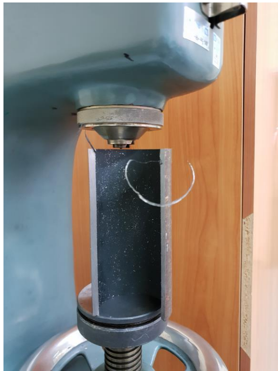
Slika 11. Mjerenje tvrdoće na novoj cijevi
