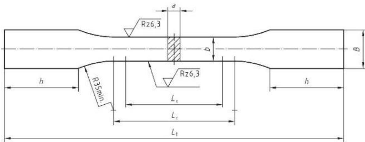
Slika 13. Dimenziije plosnate epruvete za statičko vlačno ispitivanje [16]
