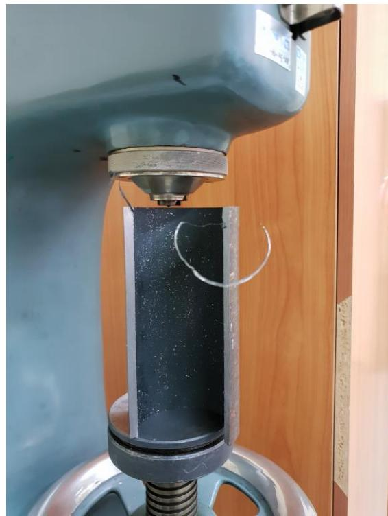
**Slika 11. Mjerenje tvrdoće na novoj cijevi**
