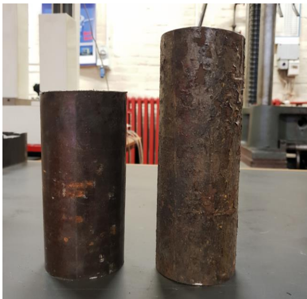
Slika 8. Nova i stara crpna cijev
