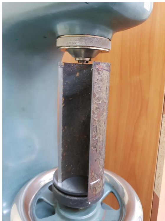
Slika 12. Mjerenje tvrdoće na staroj cijevi
