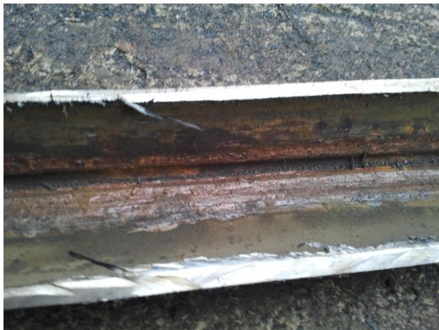
**Slika 6. Primjer oštećenja na crpnoj cijevi uzrokovanog trenjem šipke, unutarnja oštećenja (naftno polje Žutica)**
