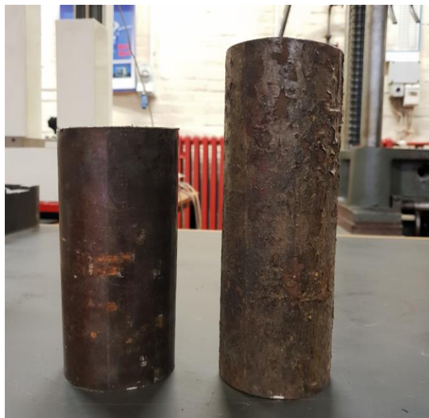
Slika 8. Nova i stara crpna cijev
