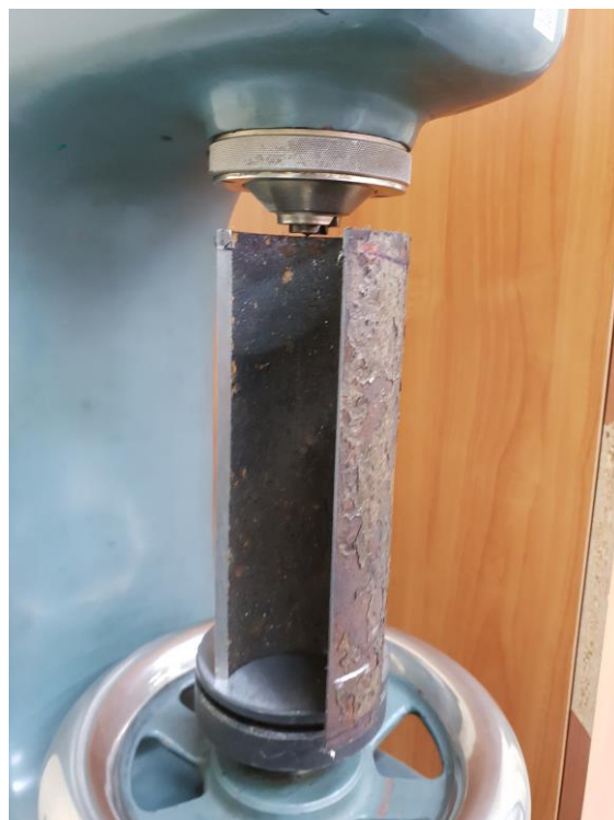
Slika 12. Mjerenje tvrdoće na staroj cijevi
