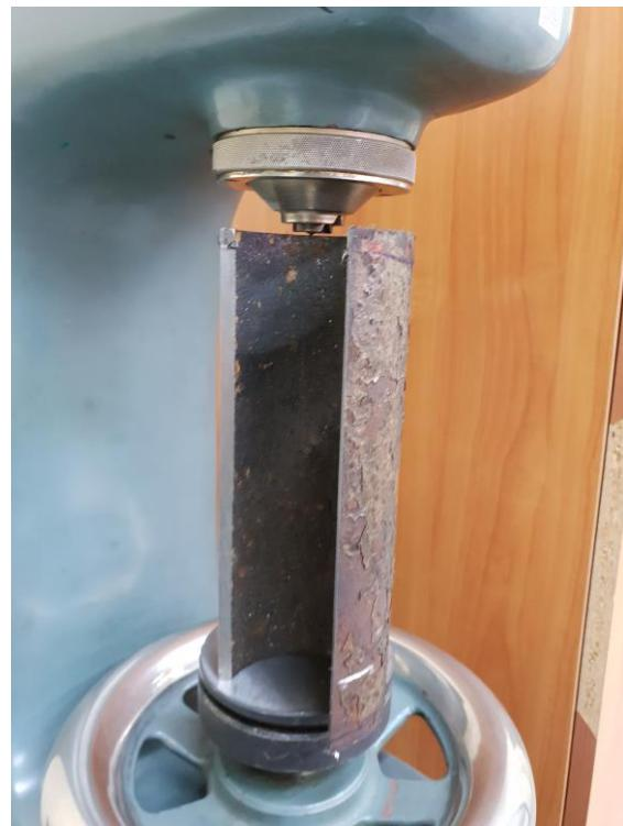
**Slika 12. Mjerenje tvrdoće na staroj cijevi**
