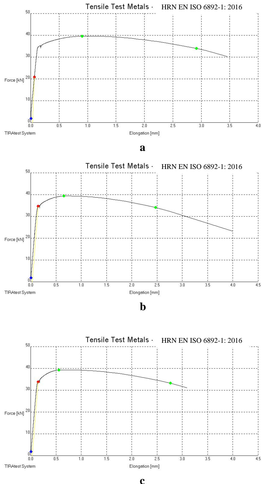
**Slika 17.**  $\sigma$  -  $\varepsilon$  dijagrami za epruvete a, b, c
