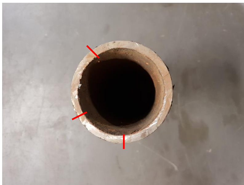
Slika 9. Prikaz stijenke i oblika nove cijevi
