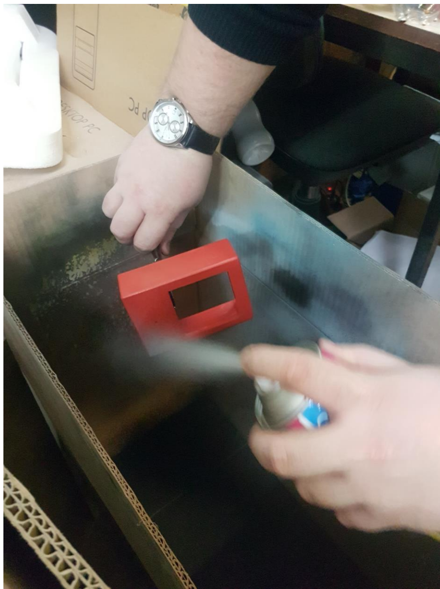
Slika 29. Prikaz postupka obrade akrilnim kitom kućišta QrBox-a
