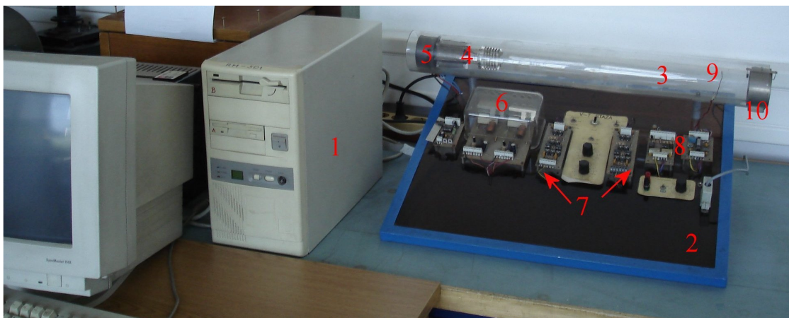
1 – upravljačko PC računalo, 2 – postolje makete s izvorom napajanja, 3 – cijev za zrak, 4 – grijači, 5 – ventilator, 6 – tiristorsko pojačalo za napajanje grijača, 7 – alternativni analogni regulatori temperature i protoka, 8 – pojačala signala s pretvornika, 9 – mjerni pretvornik temperature, 10 –mjerni pretvornik protoka.
