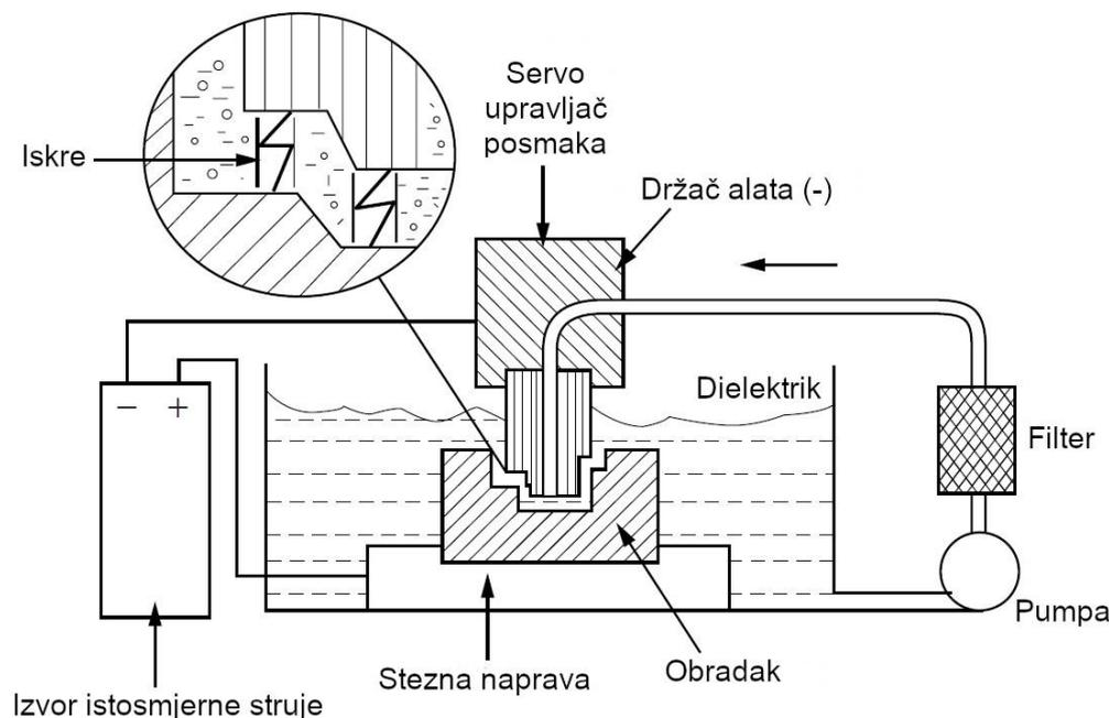
**Slika 32 Elektroerozijski postupak [22]**
