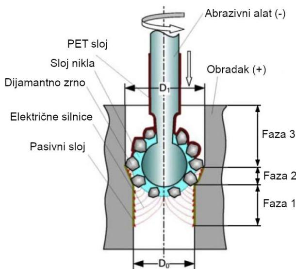
**Slika 64**  $\mu$ ECM i mikro brušenje [29]
