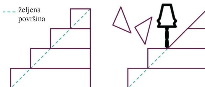
**Slika 2** Prikaz efekta stepenica (lijevo); učinak glodanja (desno) [9]
