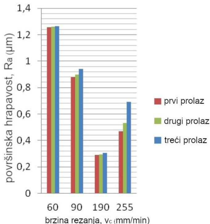
**Slika 5** Dijagram površinska hrapavost, Ra – brzina rezanja,  $v_c$  [12]
