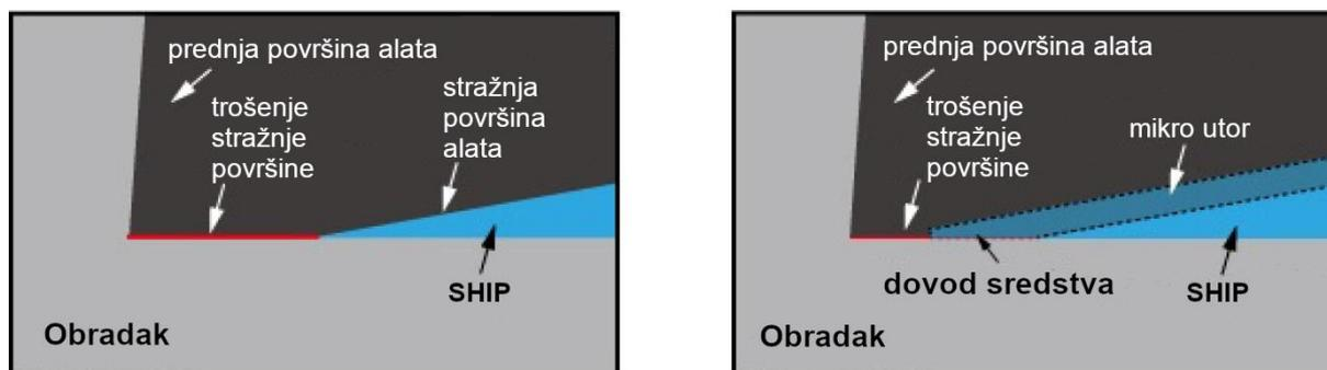
Slika 12 Shematski prikaz: (lijevo) poravnanje stražnje površine alata bez tekture i otežan dovod SHIP-a; (desno) utjecaj mikro utora na dovod SHIP-a do zone rezanja [11]
