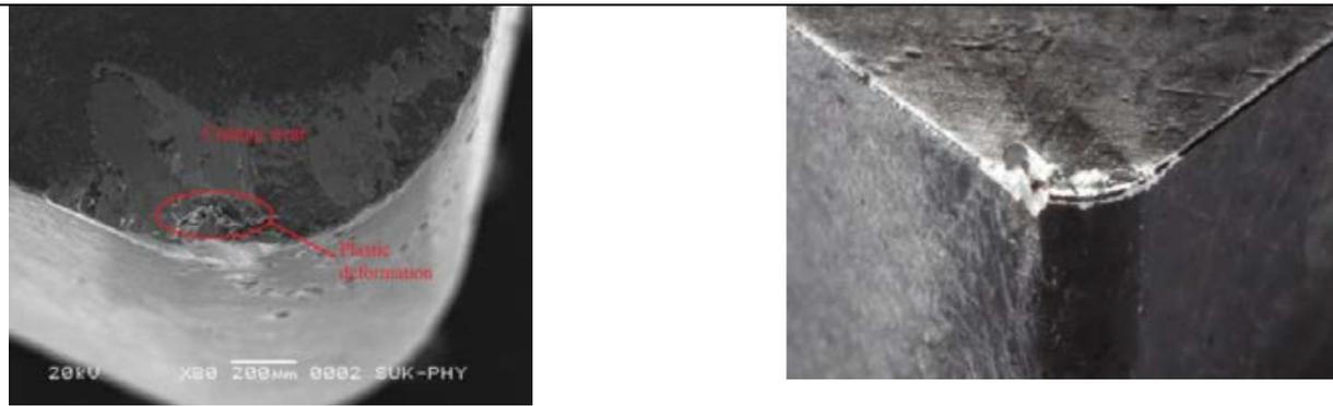
**Slika 8** Izgled trošenja alata – kratersko trošenje ( $v_c = 90$  m/min) [12]
