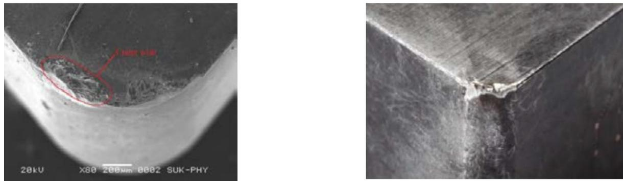
**Slika 9** Izgled trošenja alata – kratersko trošenje ( $v_c = 190$  m/min) [12]
