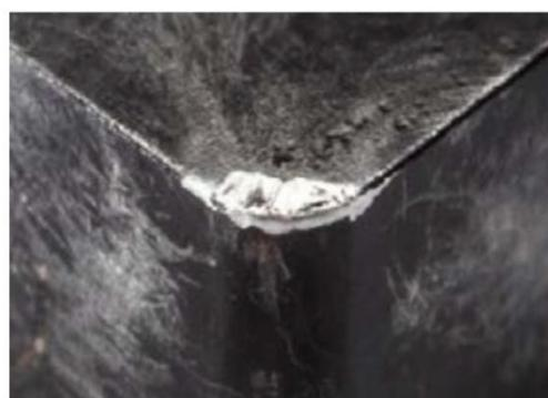
**Slika 7** Izgled trošenja alata – kratersko trošenje ( $v_c = 60$  m/min) [12]
