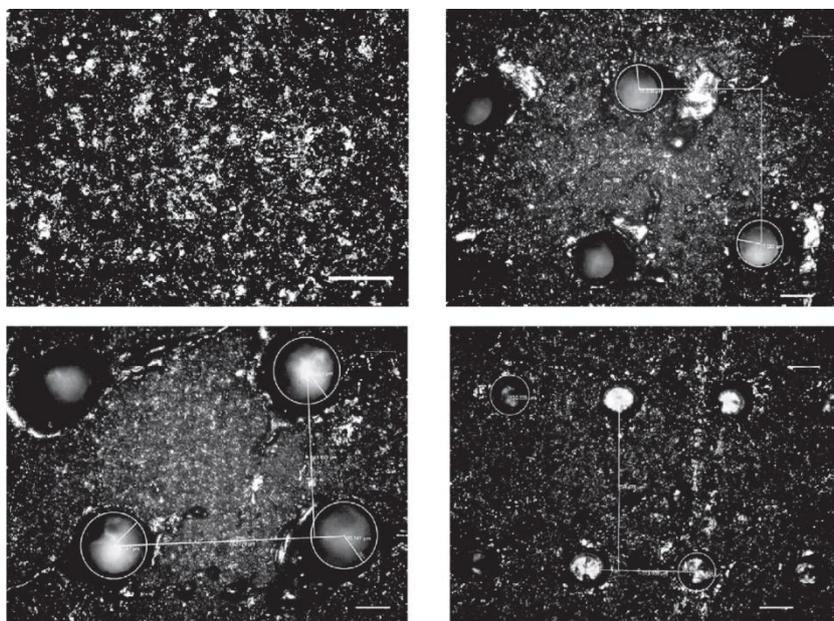
Slika 34 Različite teksture površine Ti6Al4V dobivene laserskom obradom [23]
