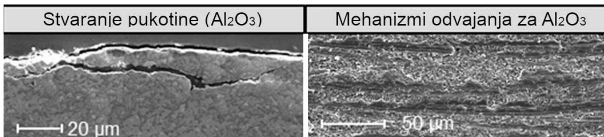
**Slika 52 lijevo: negativni utjecaj vibracija na površinu obratka od  $\text{Al}_2\text{O}_3$  (RUAG postupak) i desno: tekstura površine [8]**
