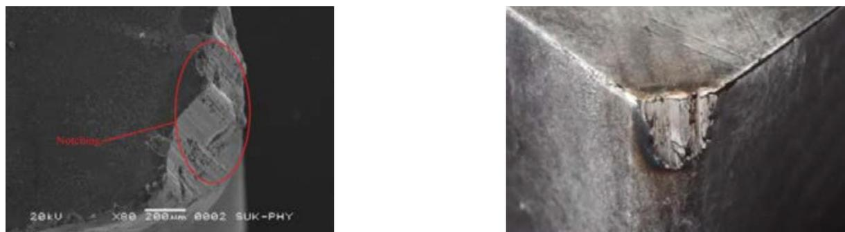
**Slika 10** Izgled trošenja alata – zarezno trošenje ( $v_c = 255$  m/min) [12]
