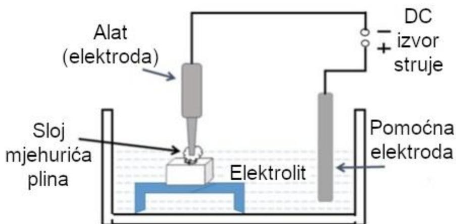
**Slika 42** Prikaz kombinacije elektroerozijskog i elektrokemijskog postupka [27]
