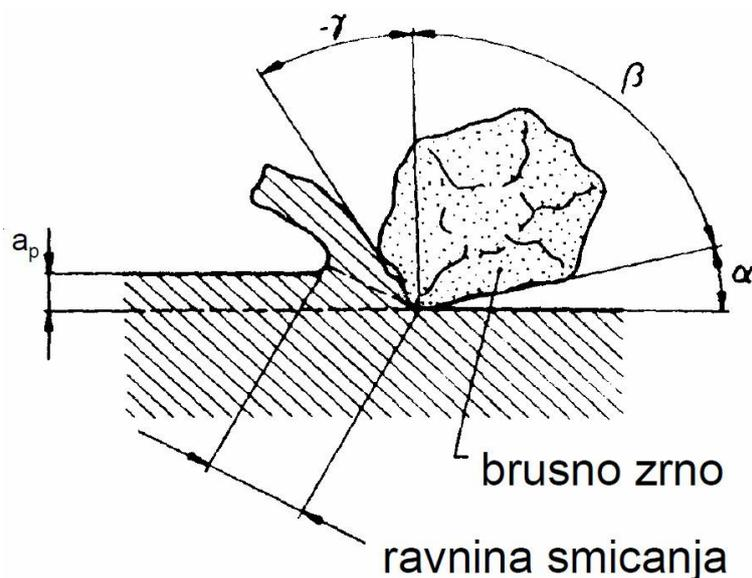
**Slika 51 Geometrija rezne oštice brusnog zrna [31]**
