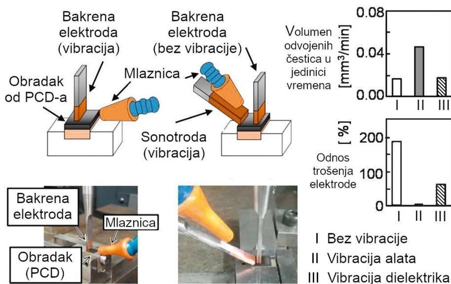
**Slika 54 Elektroerozijska obrada potpomognuta vibracijom [8]**
