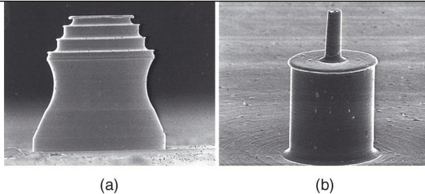
**Slika 60 Prikaz: a) obradak dobiven profilnim mikro tokarenjem, b) mikro osovina s dva različita promjera [33]**
