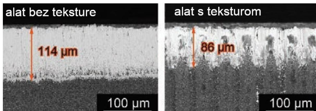
Slika 16 Stražnja površina (dužina obrade: 400 m): lijevo – alata bez teksture, desno – alata s mikro utorima ( $v_c = 500$  m/min) [11]
