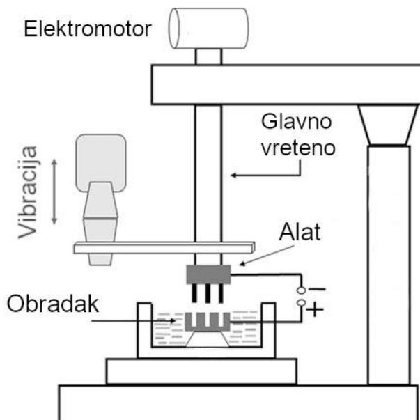
**Slika 66 Postupak elektroerozijske obrade potpomognute vibracijom [27]**
