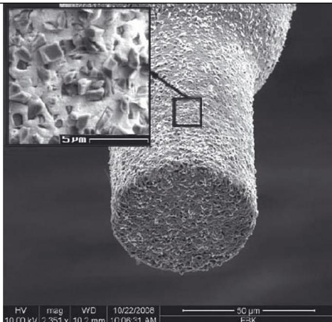
Slika 63 Prikaz mikro brusnog diska ( $\Phi$  45  $\mu\text{m}$ ) i zrna (veličina: 1 – 3  $\mu\text{m}$ ) [33]
