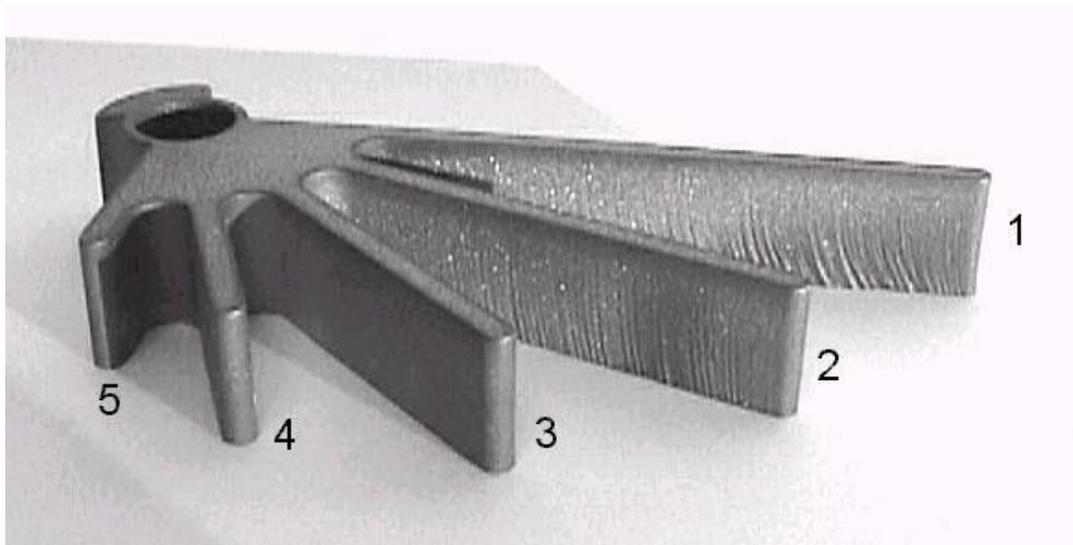
**Slika 31 Primjer valovitog traga na površini obrade vodenim mlazom [25]**
