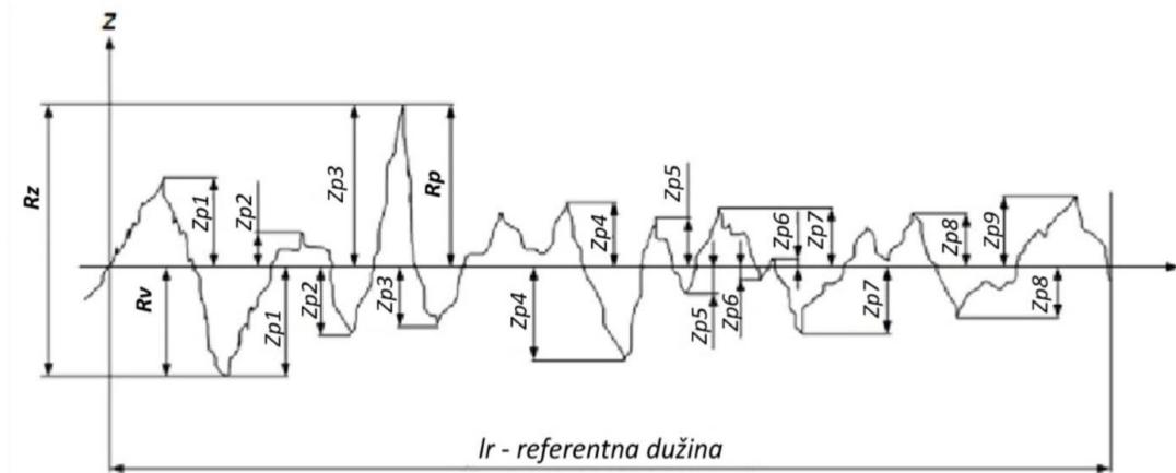
Slika 24. Amplitudni parametri hrapavosti  $R_p$ ,  $R_v$  i  $R_z$  [12]
