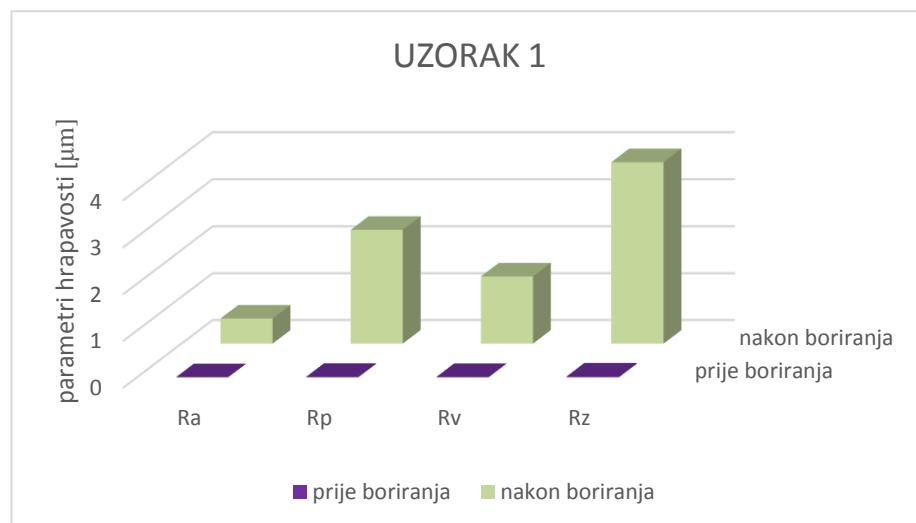
**Slika 25. Grafički prikaz parametara hrapavosti za uzorak 1**
