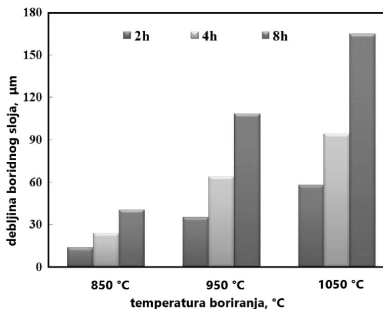
Slika 13. Ovisnost debljine boriranog sloja o temperaturi boriranja [11]
