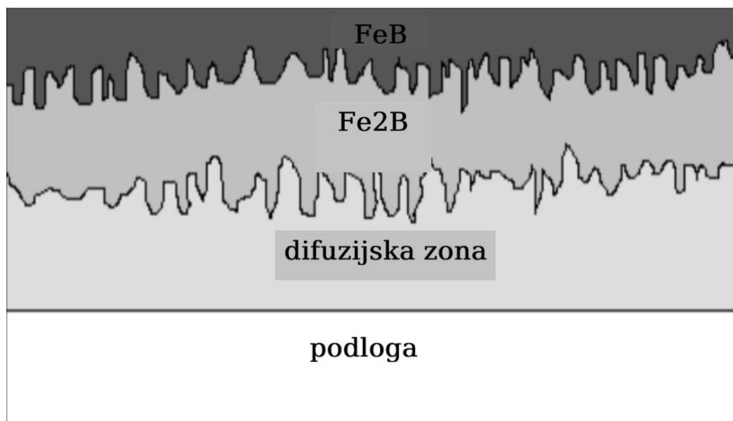
**Slika 5. Slojevi borirane površine [6]**
