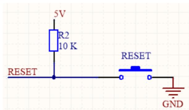
Slika 26. Shema spajanja tipke za resetiranje mikrokontrolera
