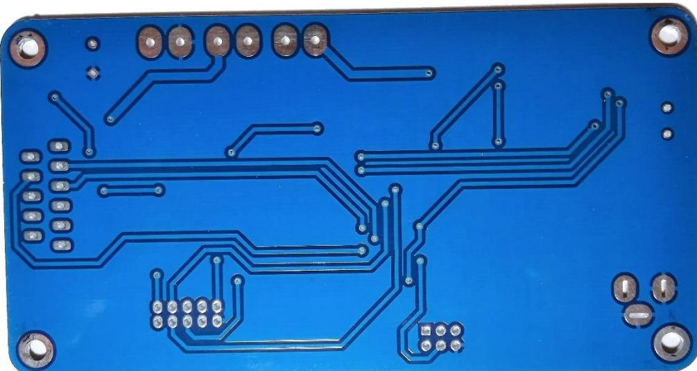
Slika 39. Stražnja strana PCB-a upravljačke jedinice istosmjernog motora
