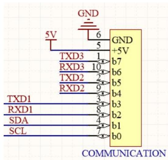
Slika 29. Shema spajanja konektora za komunikaciju i mikrokontrolera
