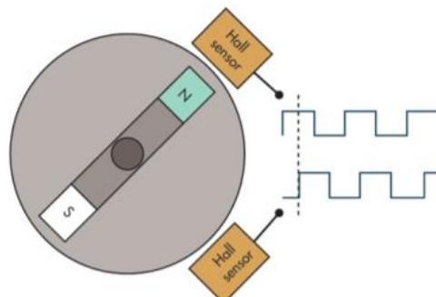
Slika 17. Princip rada magnetskog inkrementalnog enkodera
