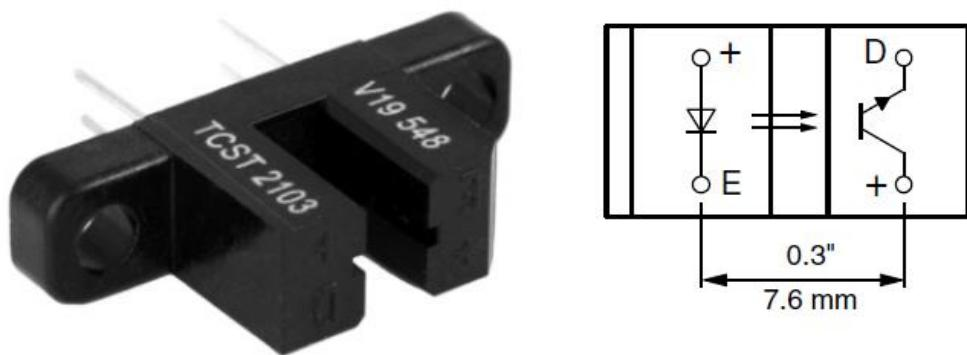
Slika 19. TCST2103 optički senzor za inicijalizaciju početnog položaja
