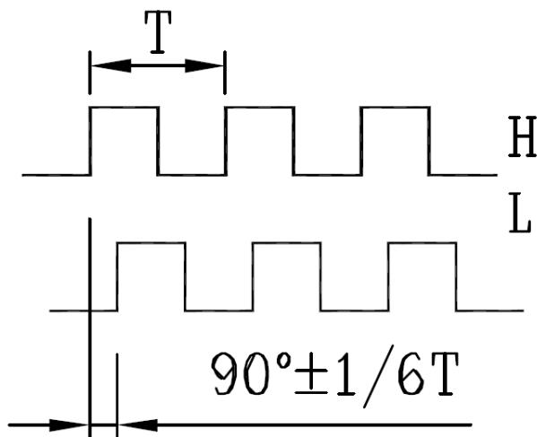
Slika 18. Prikaz signala s inkrementalnog magnetskog enkodera
