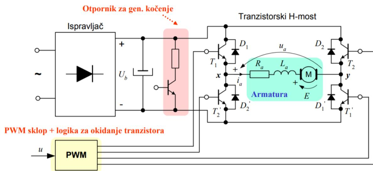
Slika 7. Shema tranzistorskog frekvencijskog pretvarača [1]
