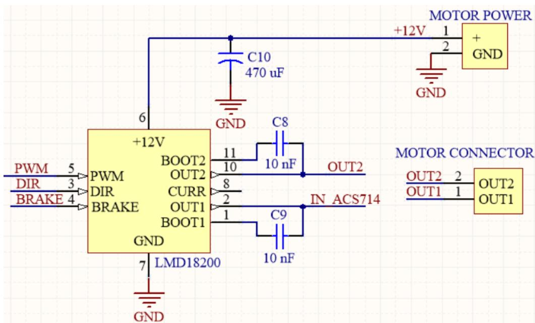
Slika 30. Shema spajanja *LMD18200* čipa i mikrokontrolera
