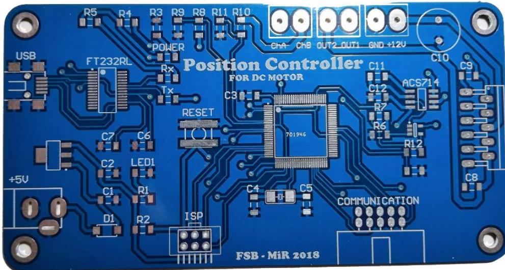
Slika 38. Prednja strana PCB-a upravljačke jedinice istosmjernog motora
