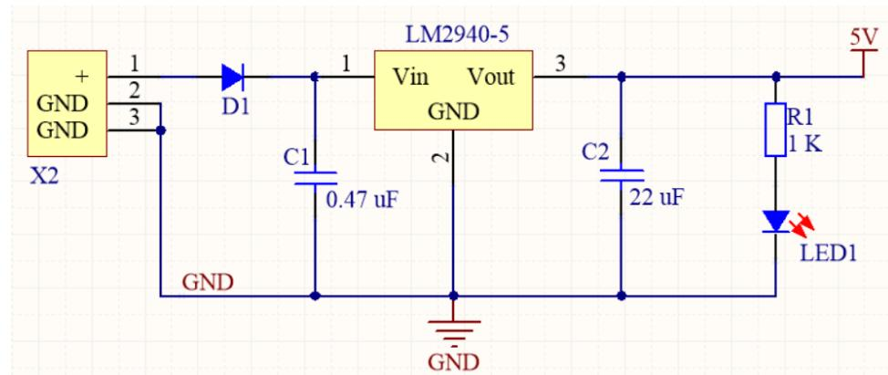
Slika 24. Shema spajanja stabilizatora napona *LM2940-5*
