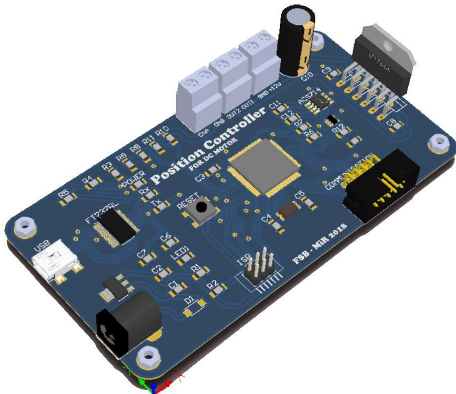
Slika 37. 3D model upravljačke jedinice istosmjernog motora
