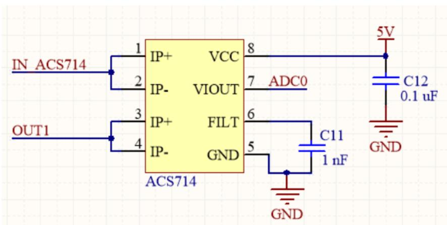
Slika 31. Shema spajanja senzora struje *ACS714ELCTR-05B* i mikrokontrolera
