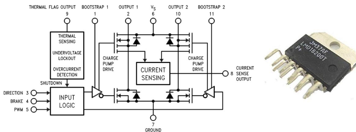
Slika 8. LMD18200 shema (lijevo), izvedba (desno)
