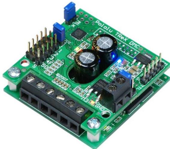
Slika 2. *TReX* kontroler DC motora marke *Pololu*
