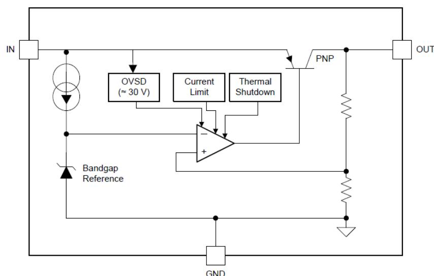
Slika 15. Shema stabilizatora napona LM2940 – 5
