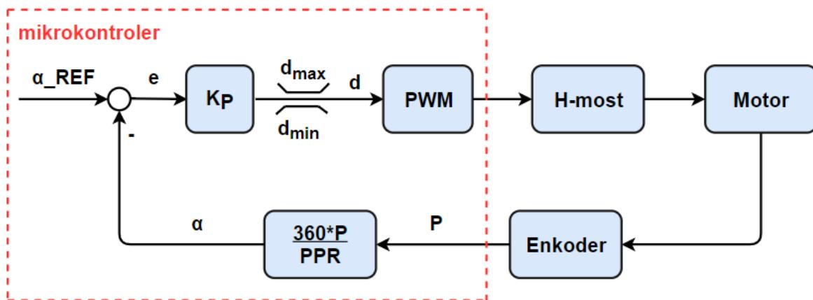
Slika 40. Struktura regulacije kuta zakreta istosmjernog motora
