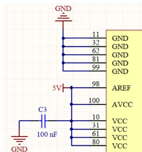
Slika 25. Prikaz spajanja napajanja i uzemljenja mikrokontrolera
