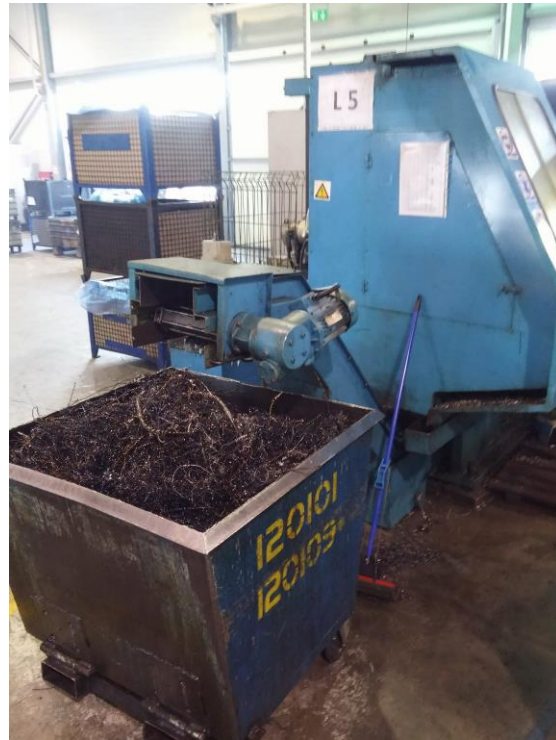
Slika 5.5. Sustav za odvođenje odvojenih čestica iz stroja
