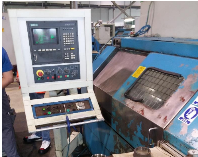
Slika 5.21. Konzola NC stroja
