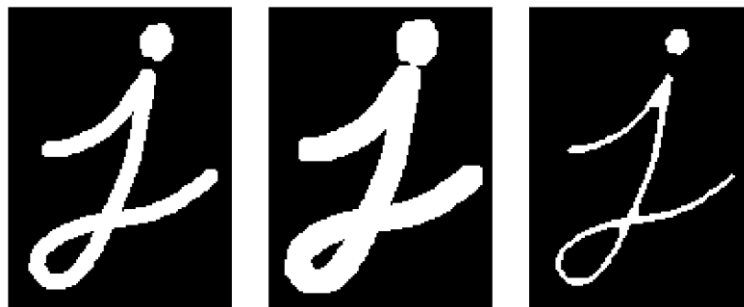
Slika 13. Originalni lik, dilatirani lik i erodirani lik
