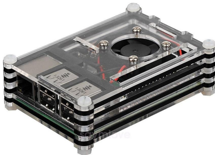
Slika 7. Raspberry Pi Model 3 B+ u kućištu sa spojenim ventilatorom
