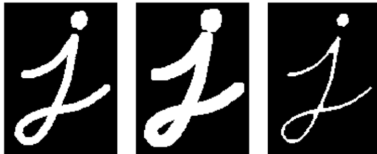
Slika 13. Originalni lik, dilatirani lik i erodirani lik
