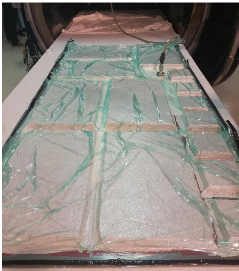
Slika 34. Ispitne ploče prije stavljanja u autoklav
