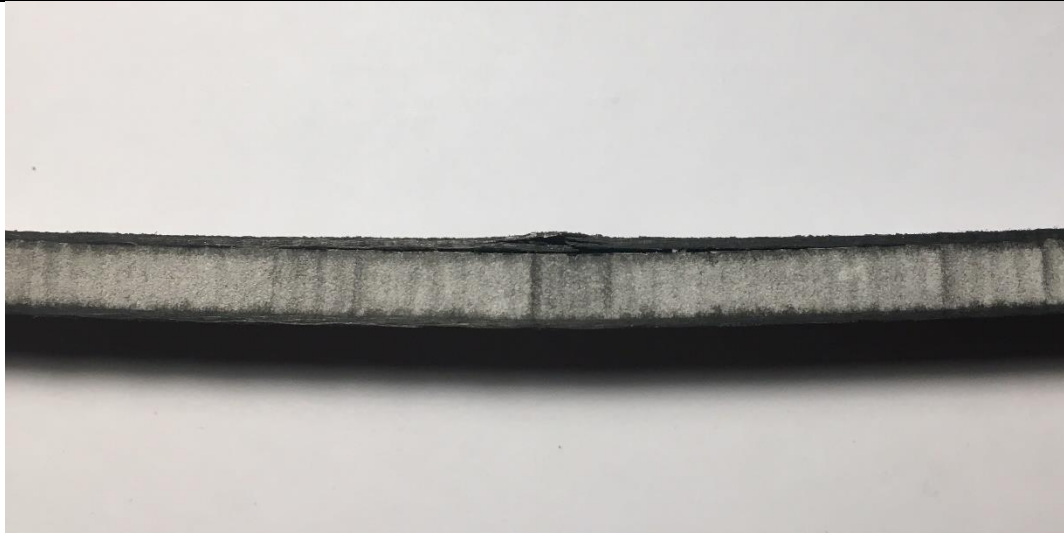
Slika 48. Popuštanje gornje ljske sendviča uzorka R200-C4
