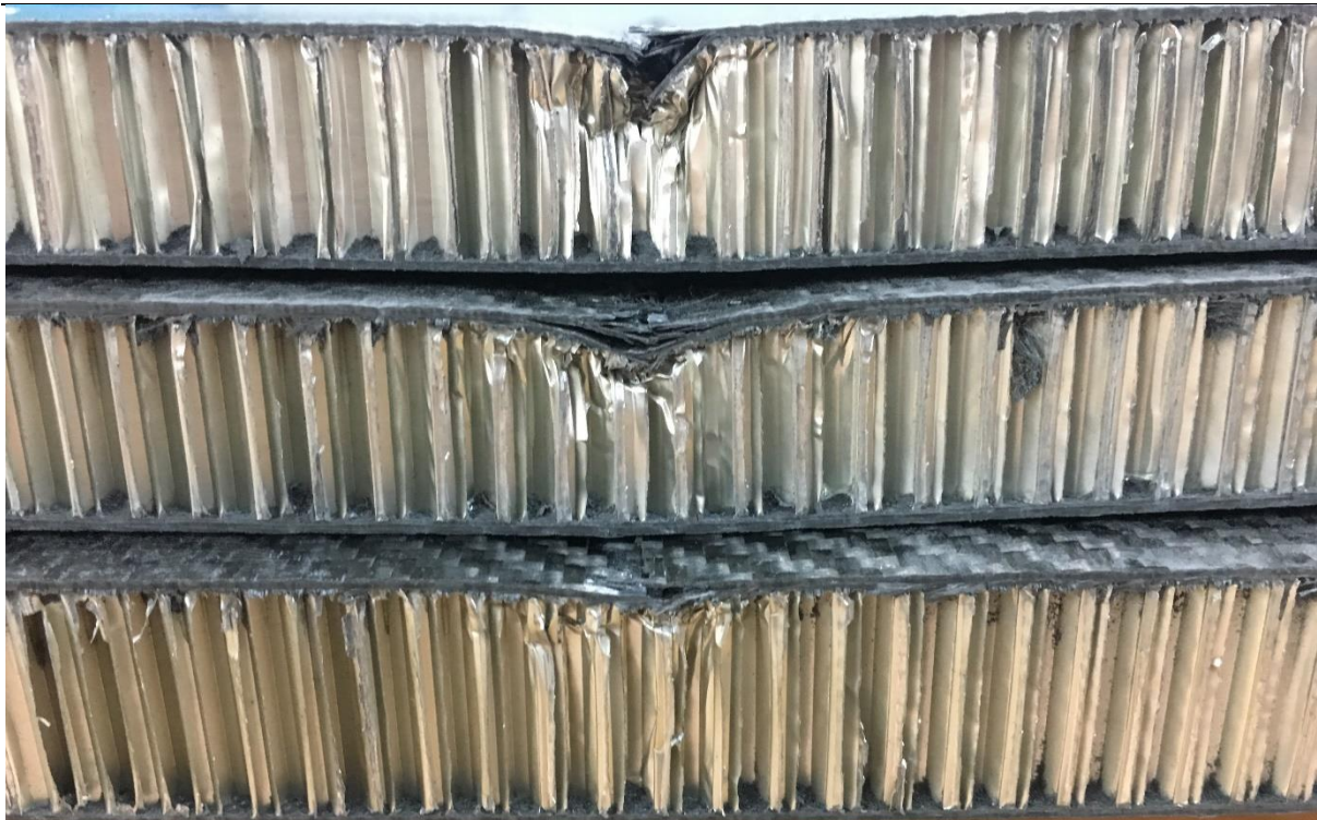
Slika 56. Ispitne ploče postava 1 do 3 nakon provedenog ispitivanja
