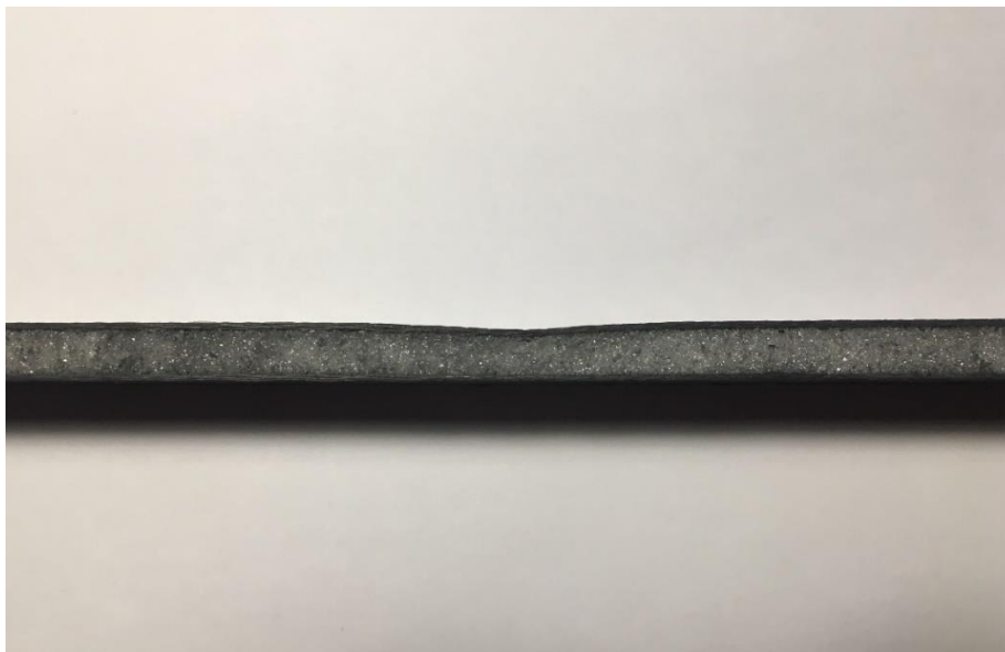
Slika 46. Utiskivanje jezgre kod uzoraka skupine R51 razreda C2 i C3
