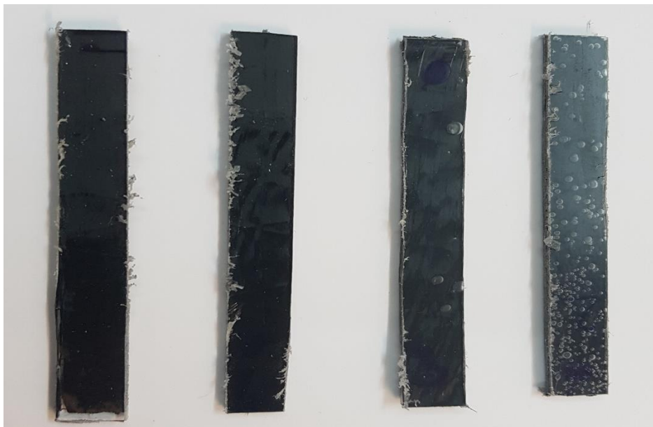
Slika 5.5. Ispitni pripreмки kompozitnih ploča za ispitivanje savojnog modula.
