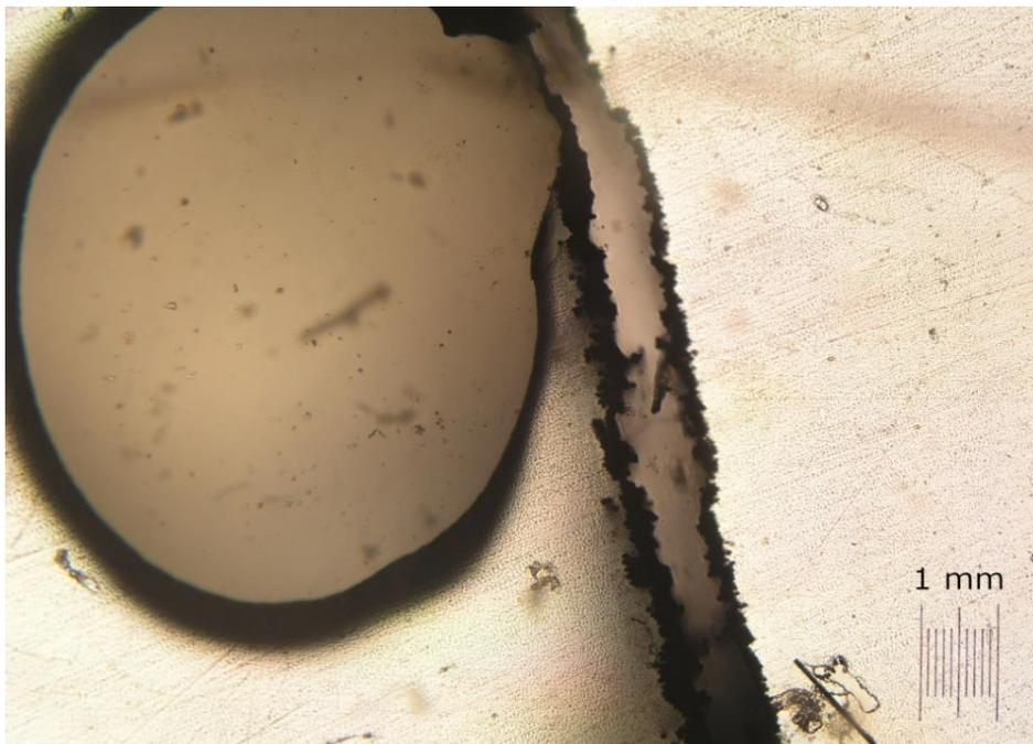
**Slika 6.2. Ploča 2 pod svjetlosnim mikroskopom, greške u materijalu.**
