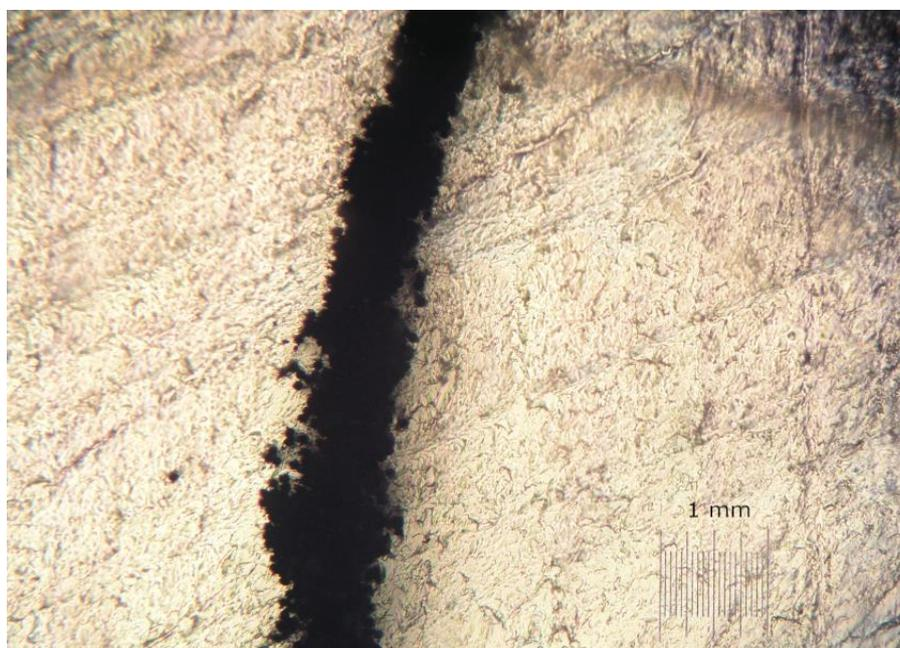
**Slika 6.4. Ploča 3 pod svjetlosnim mikroskopom, presjek okomito na smjer vlakana.**
