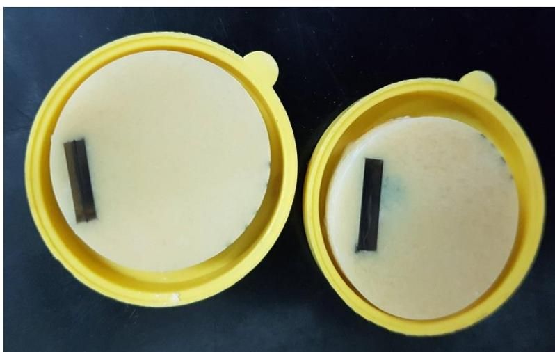
**Slika 5.2. Pripremi zaliveni u kalupu u polimernoj masi.**
