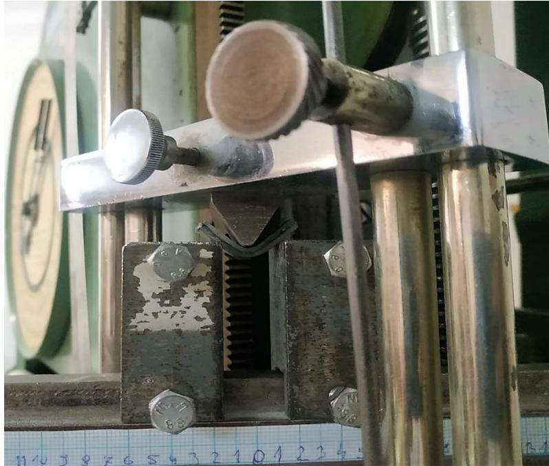
**Slika 5.7. Ispitivanje prividne smične međuslojne čvrstoće na kidalici.**
