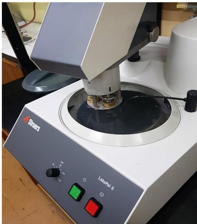
**Slika 5.3. Poliranje kompozitnih pripremaka.**
