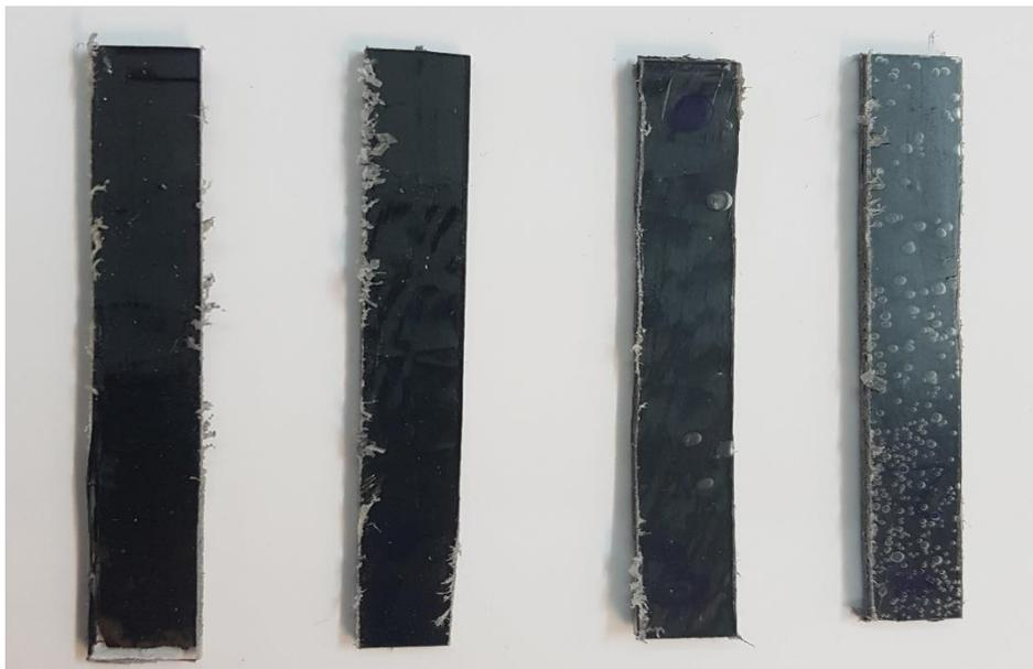
Slika 5.5. Ispitni pripreмки kompozitnih ploča za ispitivanje savojnog modula.
