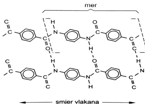
Slika 2.6. Shematski prikaz mera i lančaste strukture aramida [2].
