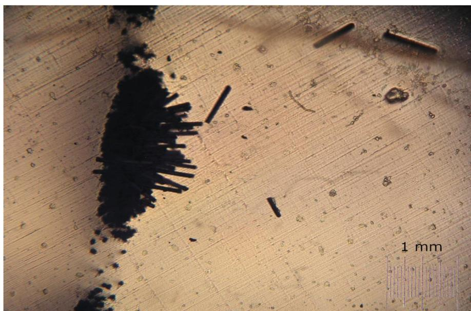
**Slika 6.8.** Ploča 5 pod svjetlosnim mikroskopom, neujednačen presjek ojačala.
