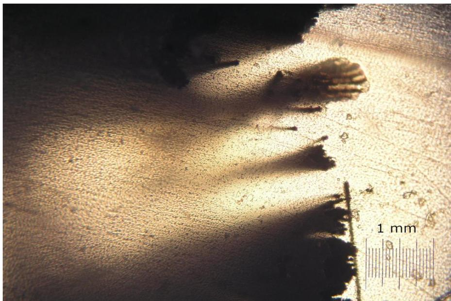
**Slika 6.5. Ploča 4 pod svjetlosnim mikroskopom, razdvajanje snopova.**
