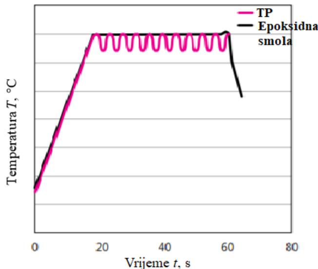
Slika 3.2. Tipični temperaturni procesi proizvodnje kompozita [13].
