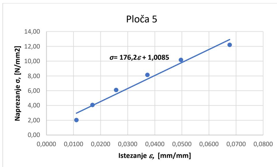
**Slika 6.13. Dijagram naprezanje - istežanje ispitnog tijela ploče 5.**
