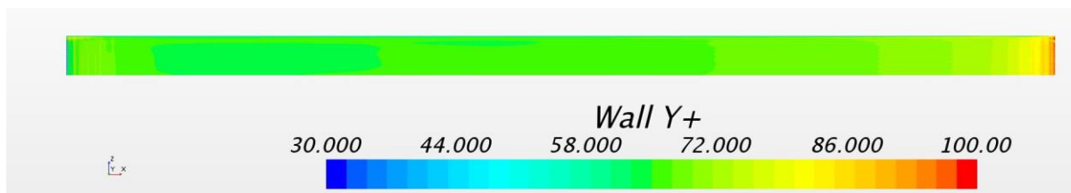
Slika 24. Raspodjela parametra y^+ za ekvivalentnu ploču za finu mrežu u kojoj su korištene zidne funkcije
