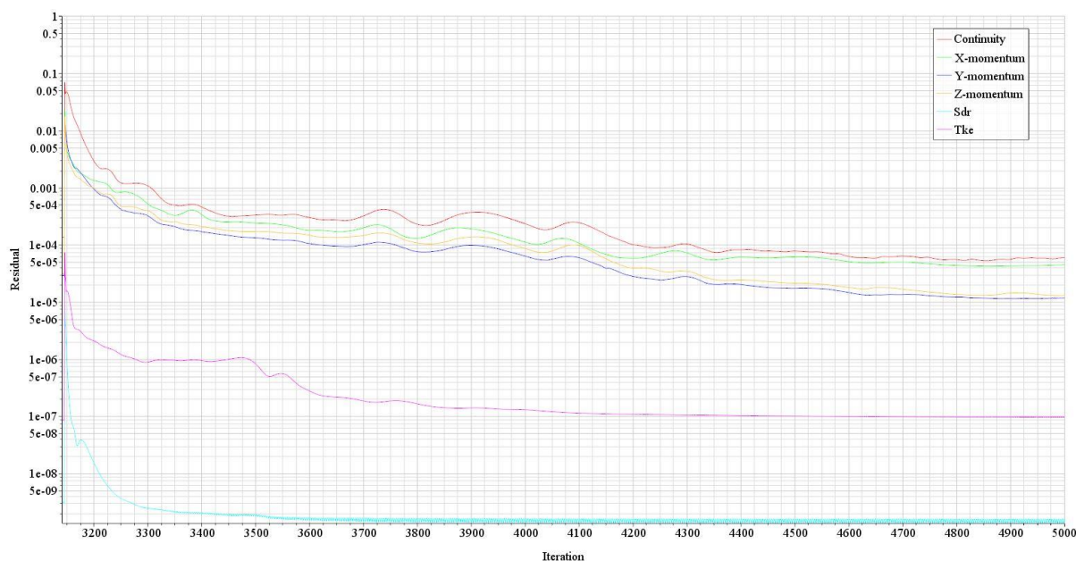
Slika 29. Reziduali numeričke simulacije ekvivalentne ravne ploče za finu mrežu dobiveni primjenom zidne funkcije
