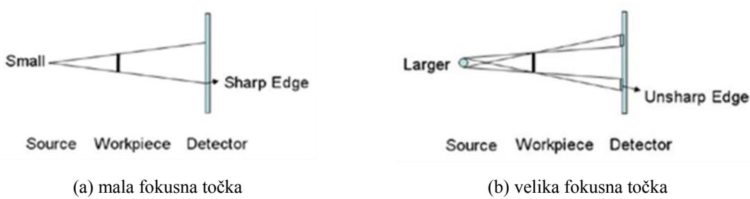
Slika 13. Efekt fokusne točke [1].
