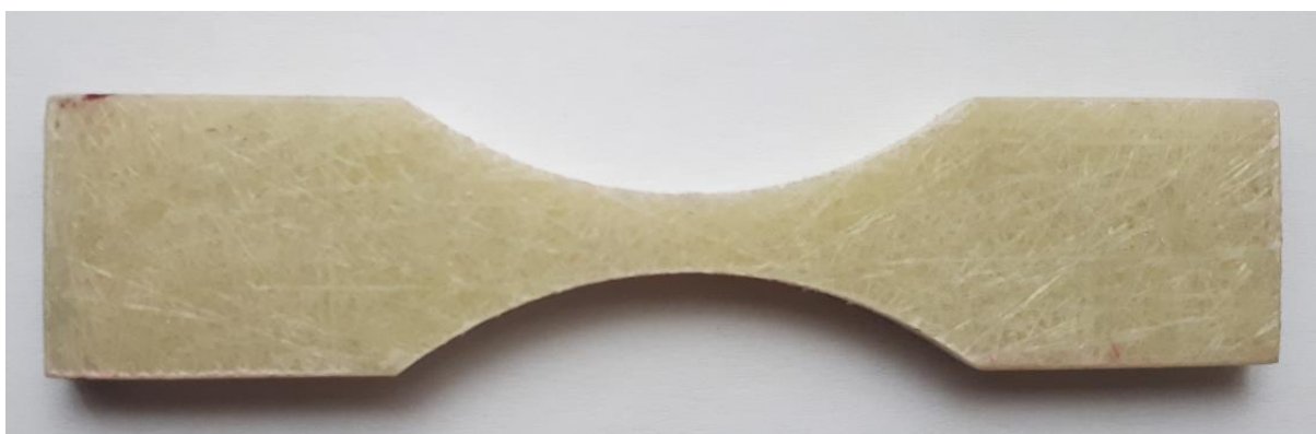
Slika 23. Uzorak za vlačno ispitivanje.
