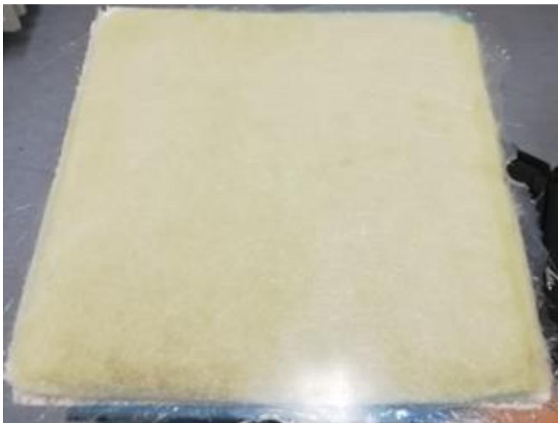
Slika 7. Izrađena polimerna kompozitna ploča ojačana mat staklenim vlknima.
