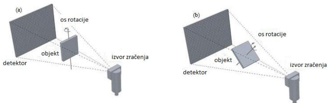
Slika 11. Shematski prikaz postava za (a) računalnu tomografiju i (b) računalnu laminografiju. [15].
