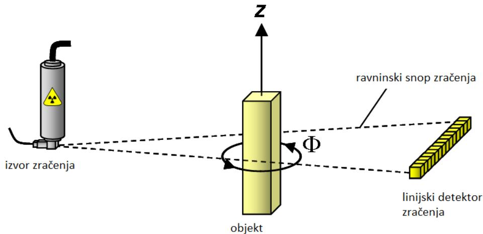
Slika 10. Shematski prikaz pojednostavljenog 2D CT uređaja [14].
