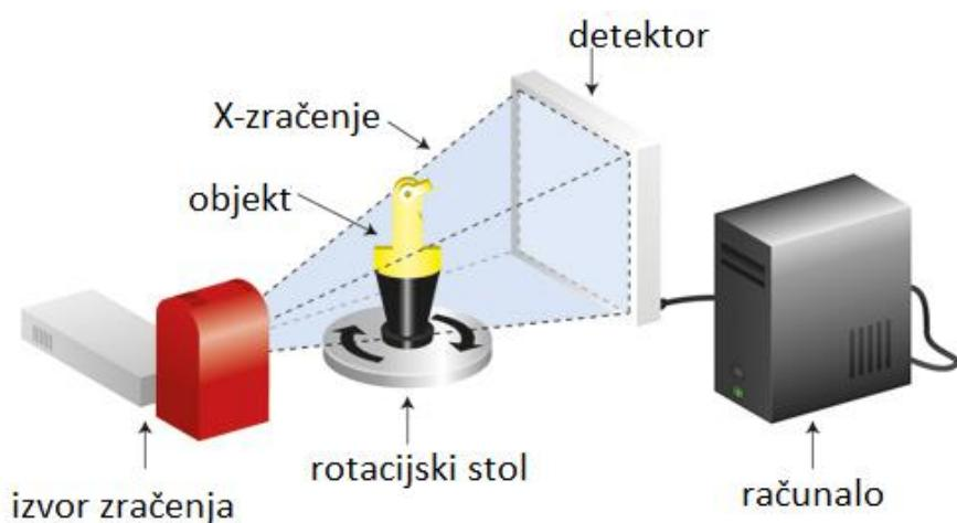
Slika 9. Shematski prikaz osnovnih dijelova 3D CT uređaja [13].
