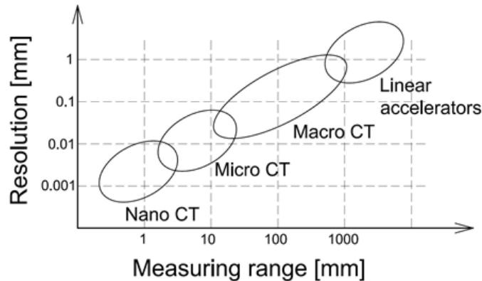
Slika 12. Ovisnost rezolucije o mjernom području za određene vrste industrijskih uređaja [1].
