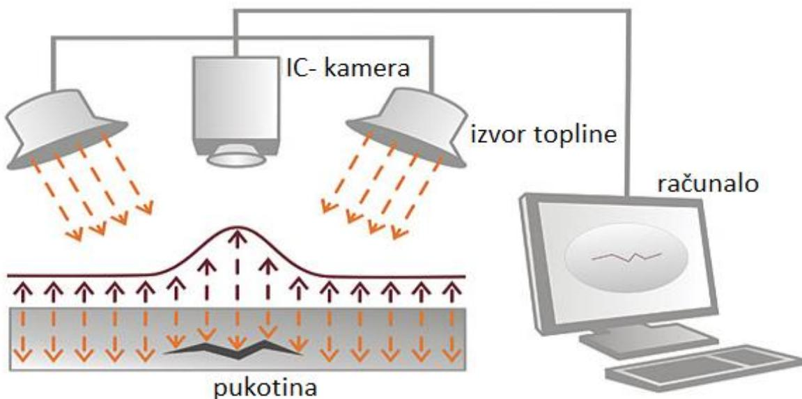
Slika 8. Shematski prikaz principa rada termografije [10].
