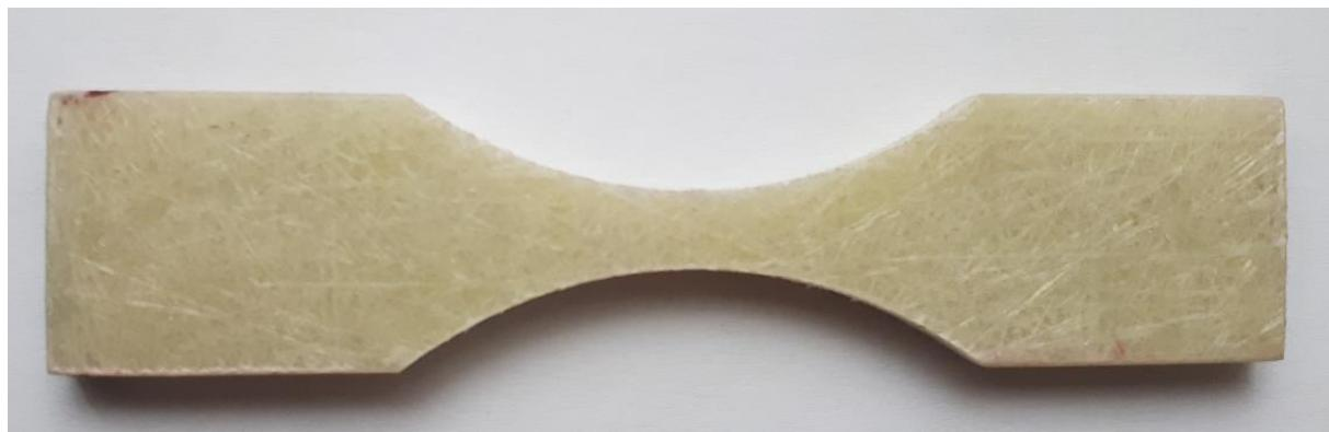
Slika 23. Uzorak za vlačno ispitivanje.
