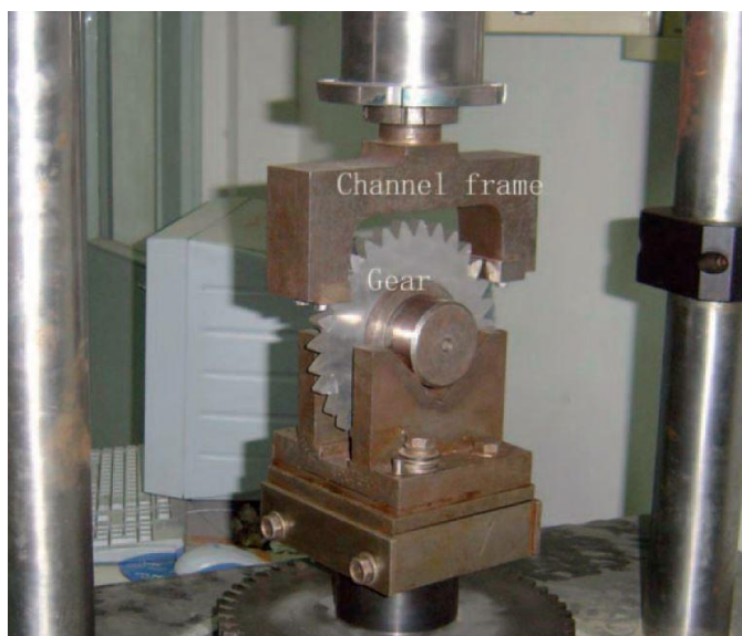
Slika 16. Ispitno postolje za opterećenje zupčanika u tri točke [17]
