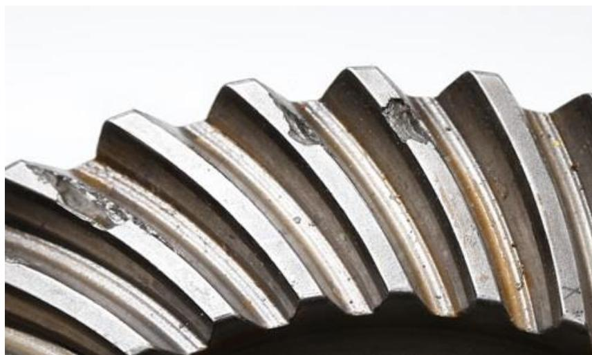
Slika 4. Oštećenje zuba stranim tijelom u zahvatu [5]
