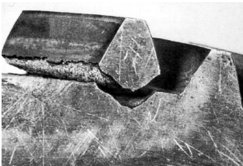
Slika 5. Nasilni lom zuba [7]
