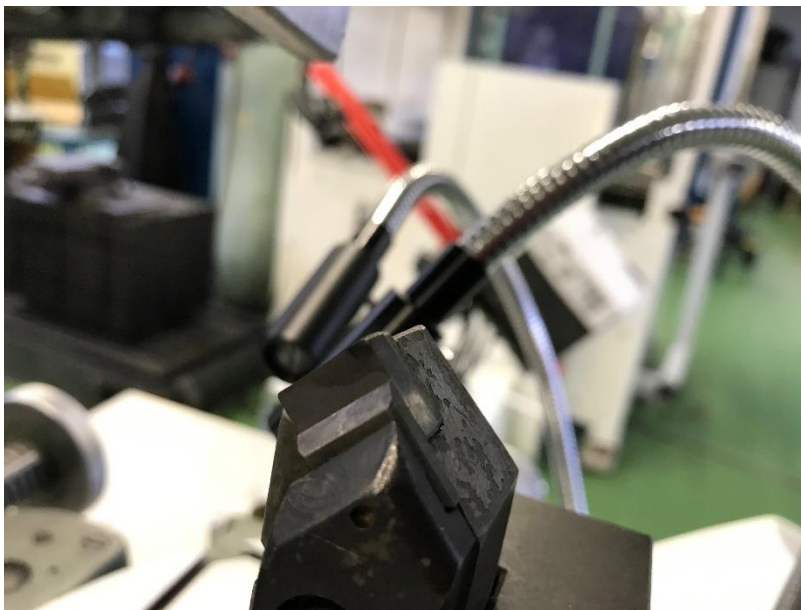
Slika 44. Rezna pločica pričvršćena u držaču
