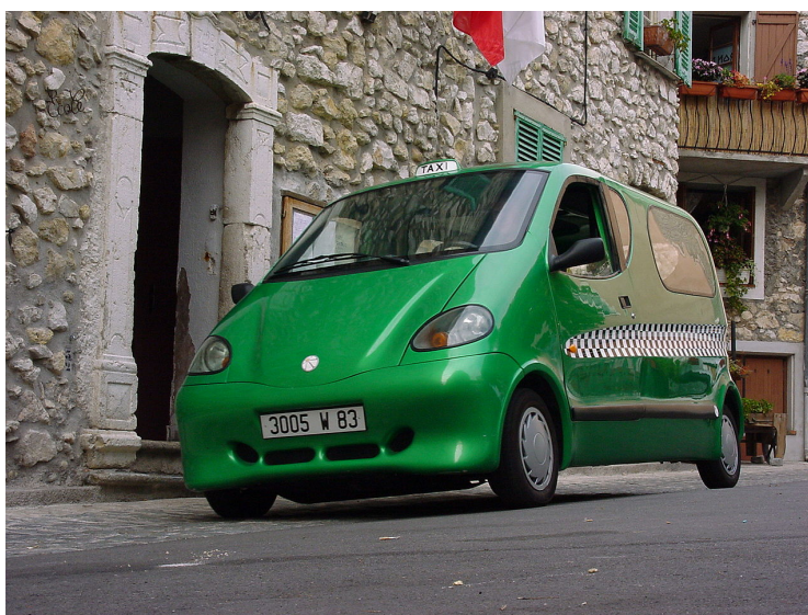
Slika 1.1 Primjer hibridnog motornog vozila sa pneumatskim pogonom [2]
