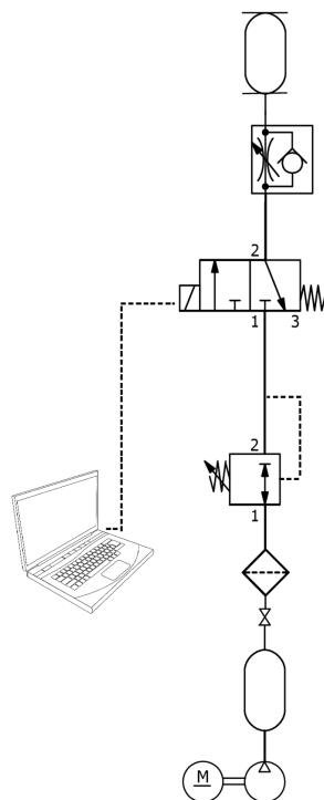
**Slika 4.14 Pneumatska shema za jedan aktuator vozila**
