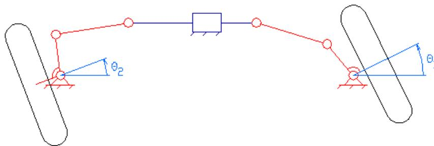
Slika 3.3 Shema geometrije rack and pinion skretanja [15]
