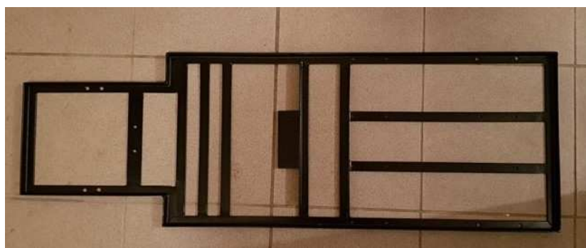
Slika 3.10 Izrađena šasija vozila
