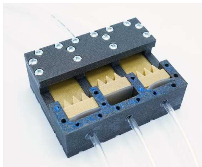
Slika 3.12 Izgled dovršenog pneumatskog linearног koračnog motora
