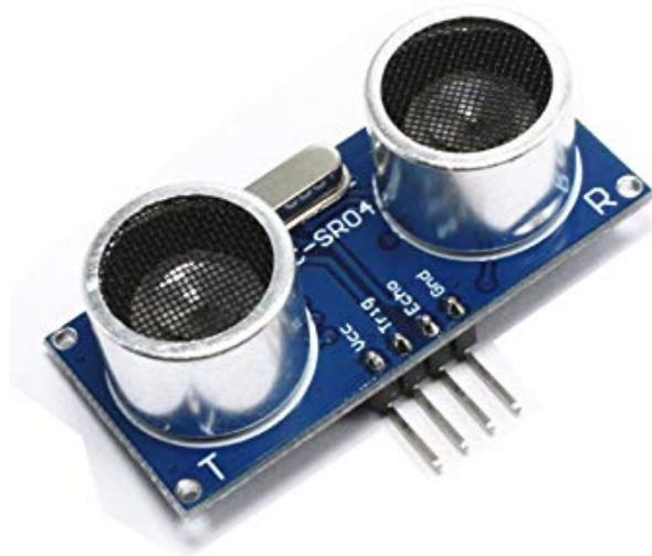
**Slika 5.3 Ultrazvučni senzor HC-SR04**
