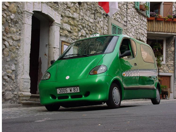
Slika 1.1 Primjer hibridnog motornog vozila sa pneumatskim pogonom [2]
