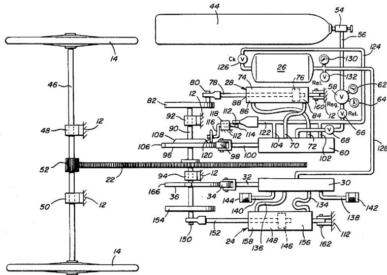
Slika 1.2 Shema pneumatskog vozila iz izvornog patenta [4]
