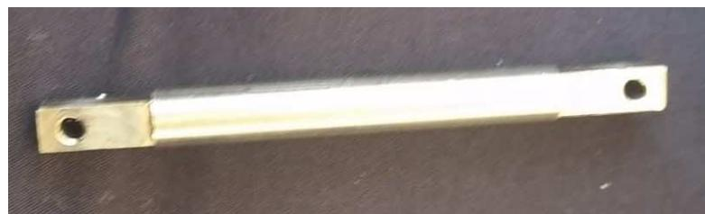
Slika 3.9 Izrađen rukavac koljenastog vratila
