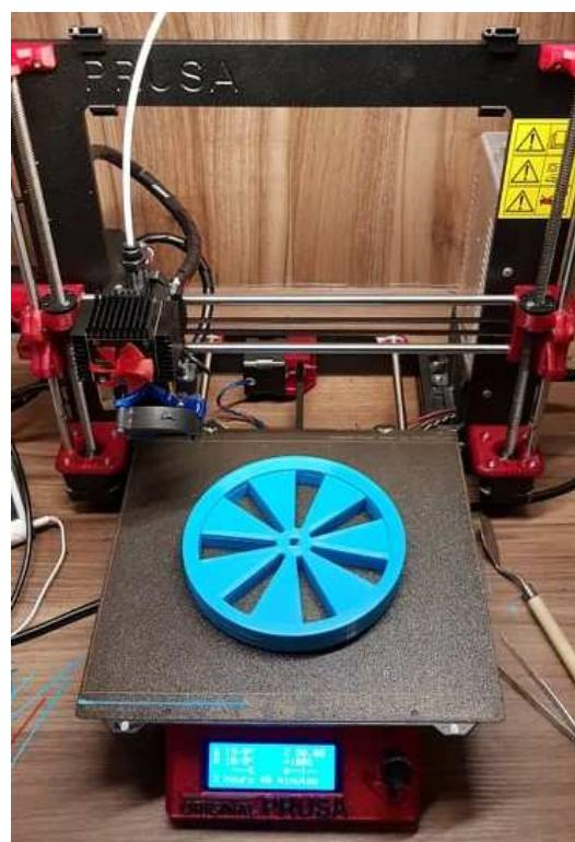
Slika 3.11 Kotač vozila izrađen na 3D printeru
