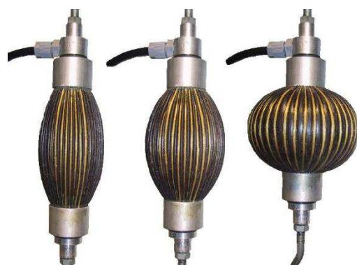
**Slika 4.3 Pneumatski mišić s uzdužnom armaturom [17]**
