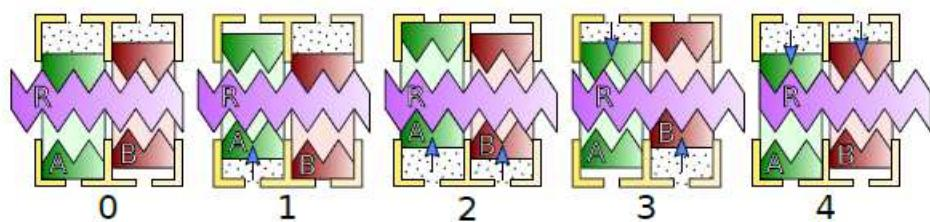
Slika 4.5 Primjer rada pneumatskog linearног koračnog motora T-63 [13]
