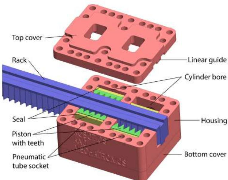
Slika 4.6 Pogled na sve dijelove pneumatskog linearног motora T-63 [13]
