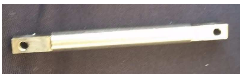
Slika 3.9 Izrađen rukavac koljenastog vratila
