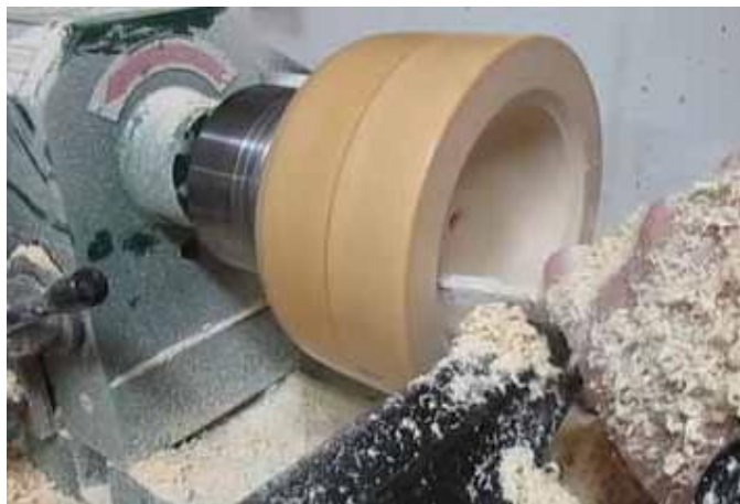
Slika 16. Poprečno unutarnje tokarenje [13]
