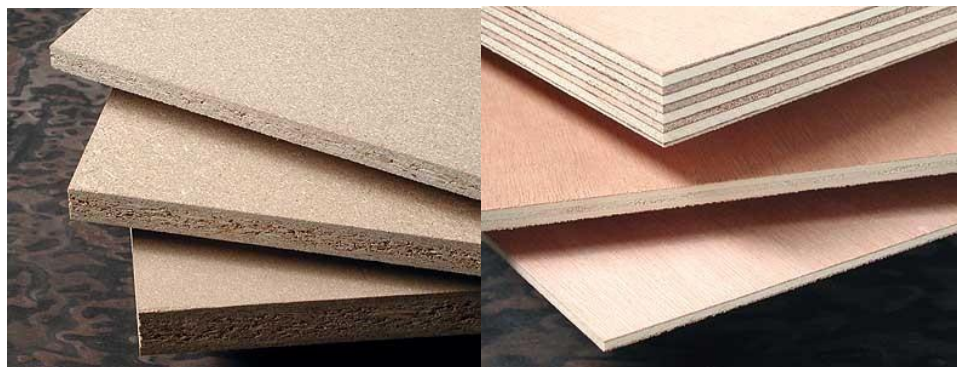
Slika 5. Iverica (lijevo) i šperploča (desno) [8]
