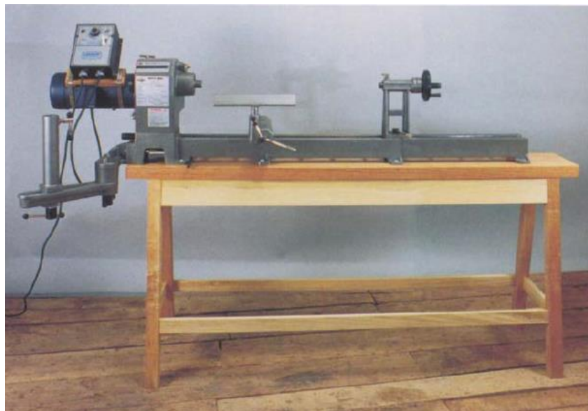
Slika 30. Primjer tokarilice srednje klase, NOVA 3000 [20]
