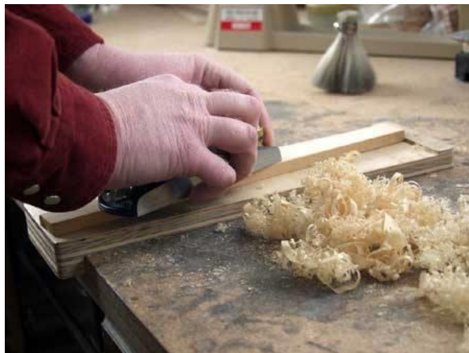
Slika 18. Prikaz ručne uzdužne obrade uz spiralnu odvojenu česticu [14]
