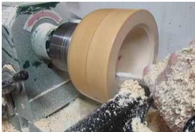
Slika 16. Poprečno unutarnje tokarenje [13]
