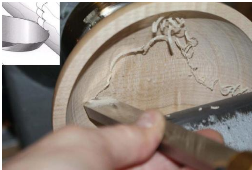
Slika 26. Obradak u zahvatu sa oblim tokarskim nožem [19]
