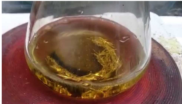
slika 3. Odvajanje zlata iz dijelova štampanih ploča pomoću dušične kiseline
