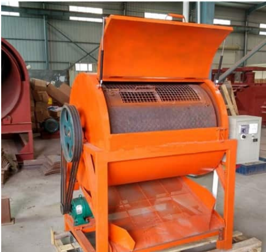
slika 6. Bujanj za odvajanje komponenti sa matičnih ploča
