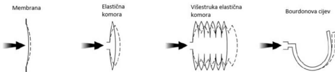
*Slika 6. Mjerni instrumenti koji koriste mehaničku deformaciju.*
