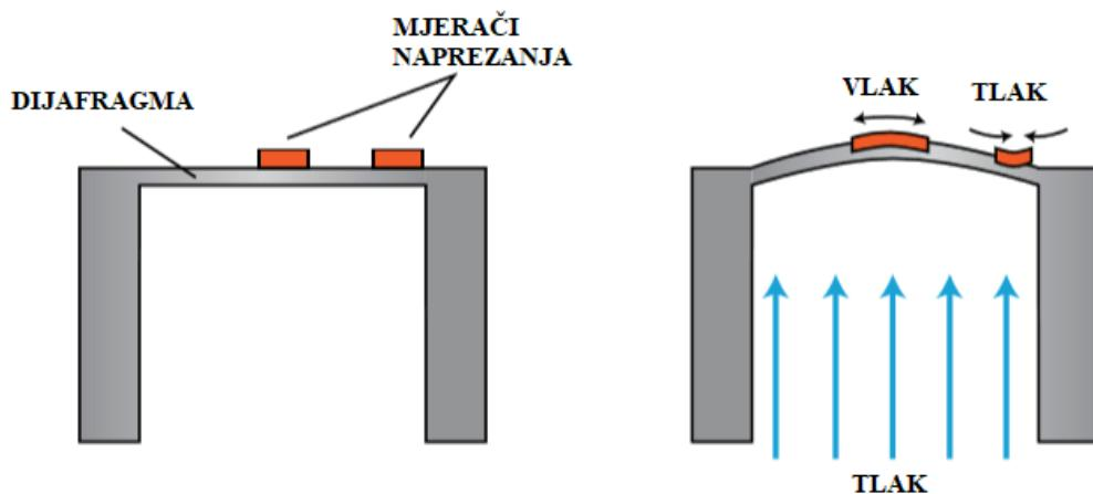
Slika 7. Otporni senzor
