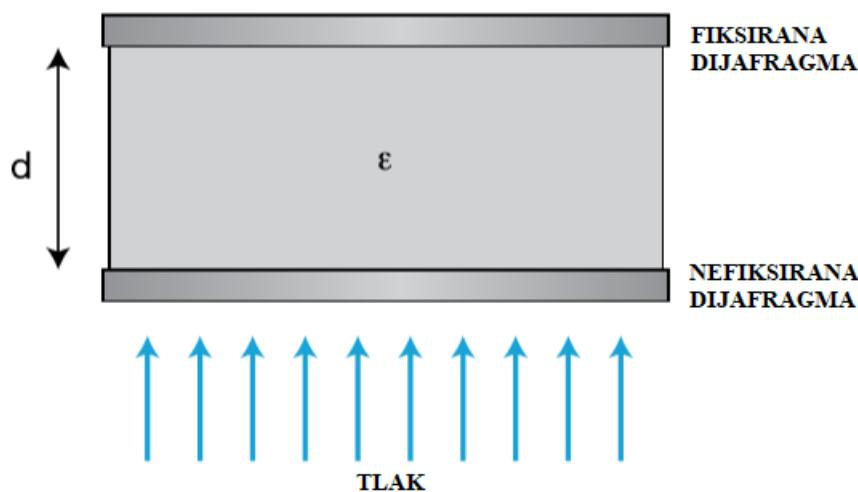
Slika 8. Kapacitivni senzor
