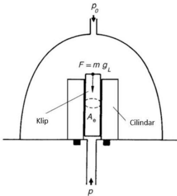
*Slika 5. Princip rada tlačne vase*
