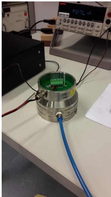
Slika 26. Pretvornik tlaka GE Druck.
