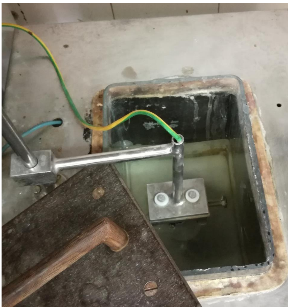
Slika 22. Komora za elektrokemijsko nagrizanje uzoraka
