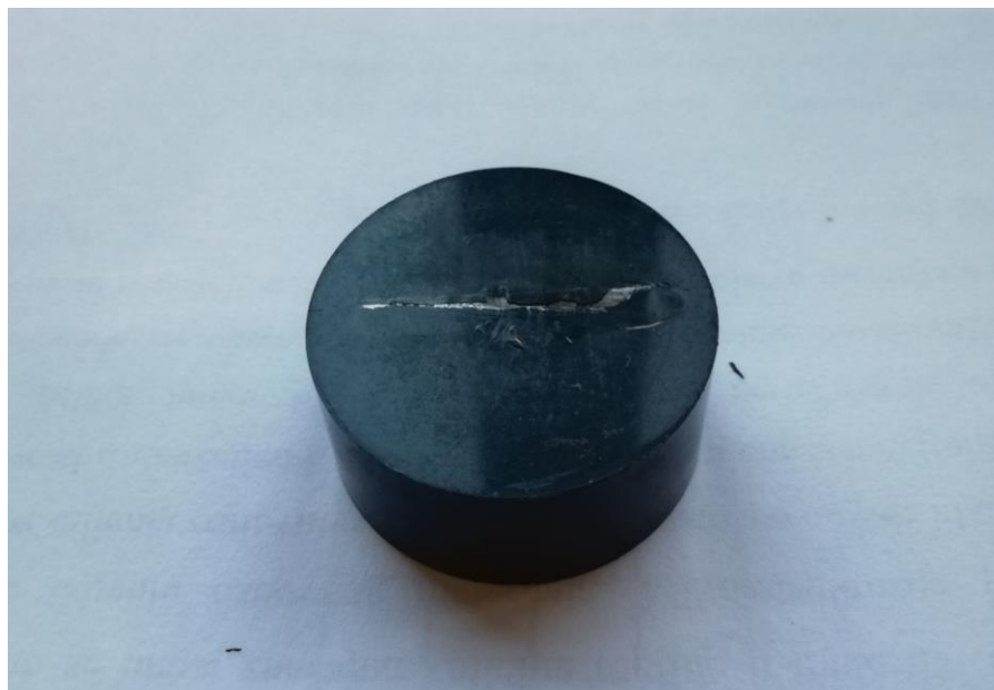
Slika 19. Metalografski uzorak nakon zalijevanja u polimernu masu
