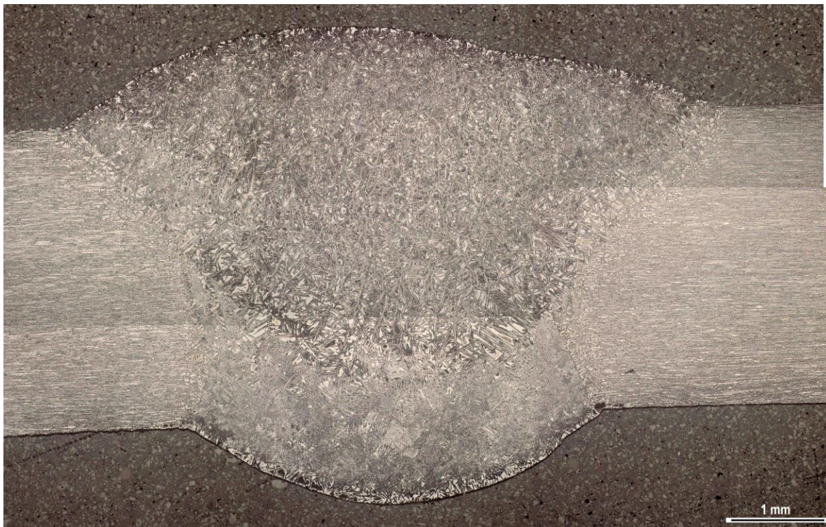
Slika 32. Makrostruktura zavarenog spoja
