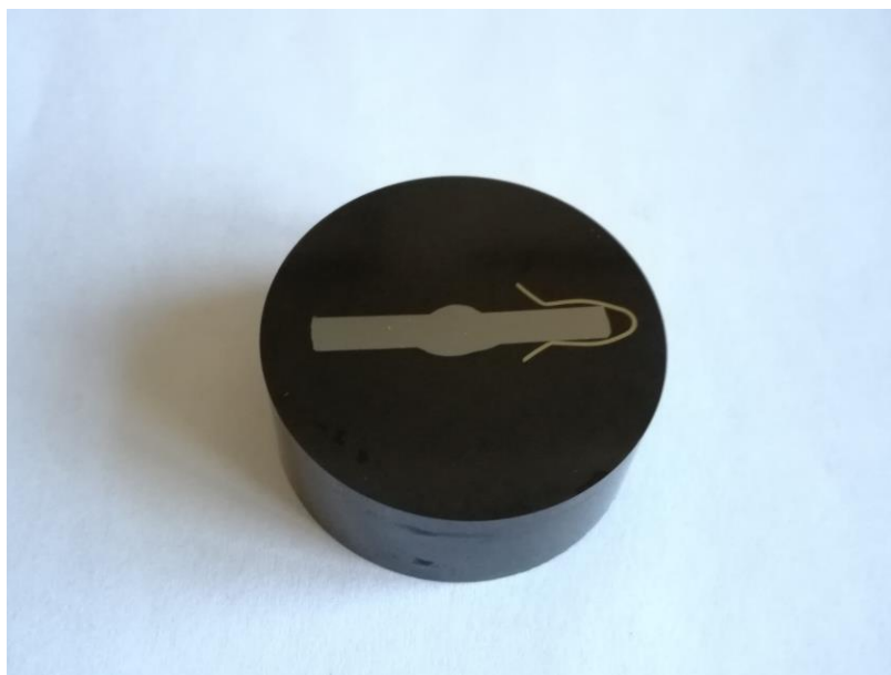
Slika 21. Metalografski uzorak nakon brušenja i poliranja
