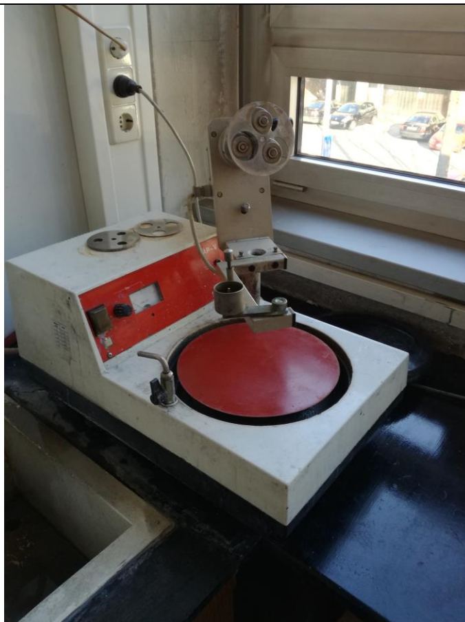
Slika 20. Uređaj za brušenje i poliranje uzoraka
